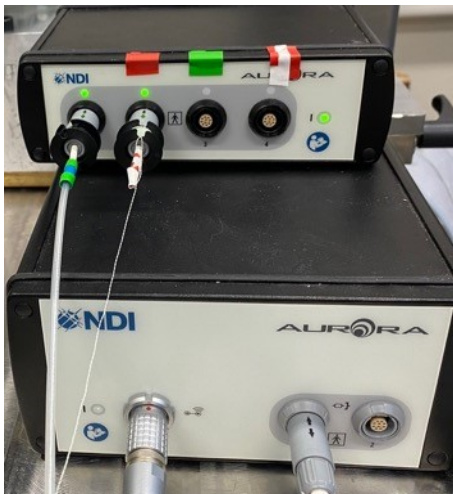
Abbildung 10: Schnittstelleneinheit mit angeschlossenen Sensoren (superior), Systemsteuerungseinrichtung (inferior).
