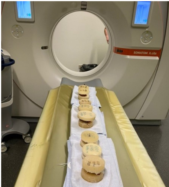
Abbildung 5: CT-Aufnahme der eingebetteten WFE.
