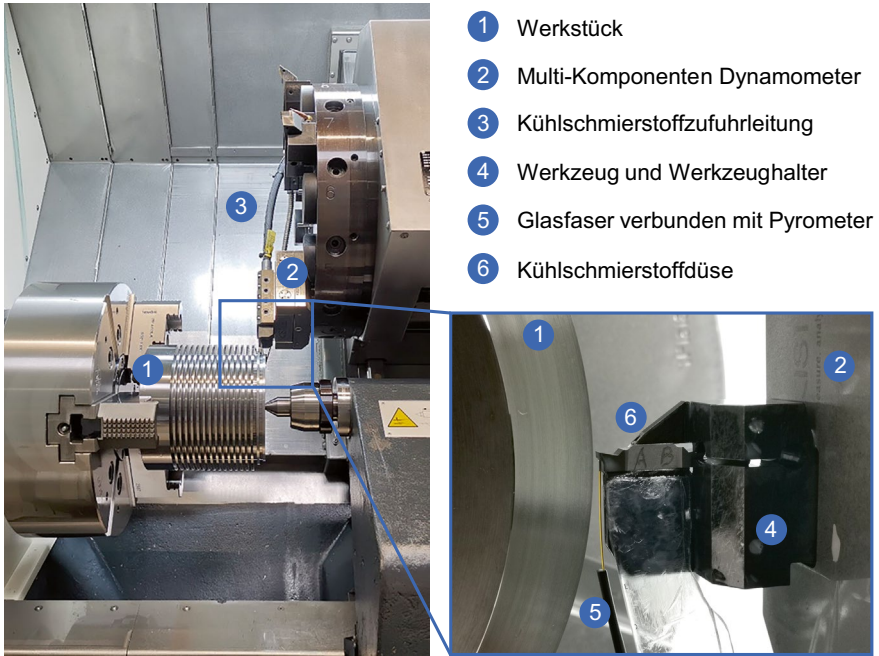
Abb. 2 Versuchsaufbau des Orthogonal Drehversuchs
