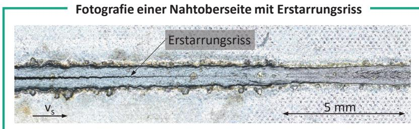
**Abbildung 4: Schweißnaht mit ausgeprägtem Erstarrungsrisse entlang der Nahtmittellinie.**
