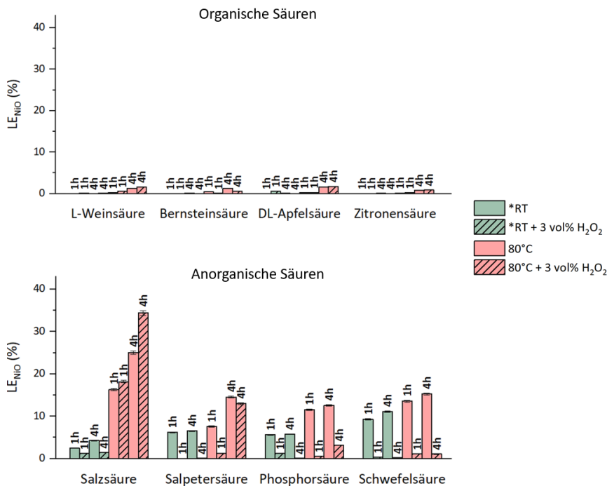
Abb. 14 Nickeloxid-Löslichkeit in verschiedenen organischen (2 M) und anorganischen Säuren (6 M). Die Bernsteinsäurekonzentration beträgt 0,5 M. Das Feststoff-Flüssigkeits-Verhältnis ist konstant auf 1 : 60 festgelegt. Die Fehlerbalken zeigen die relative Standardabweichung; *RT Raumtemperatur.
