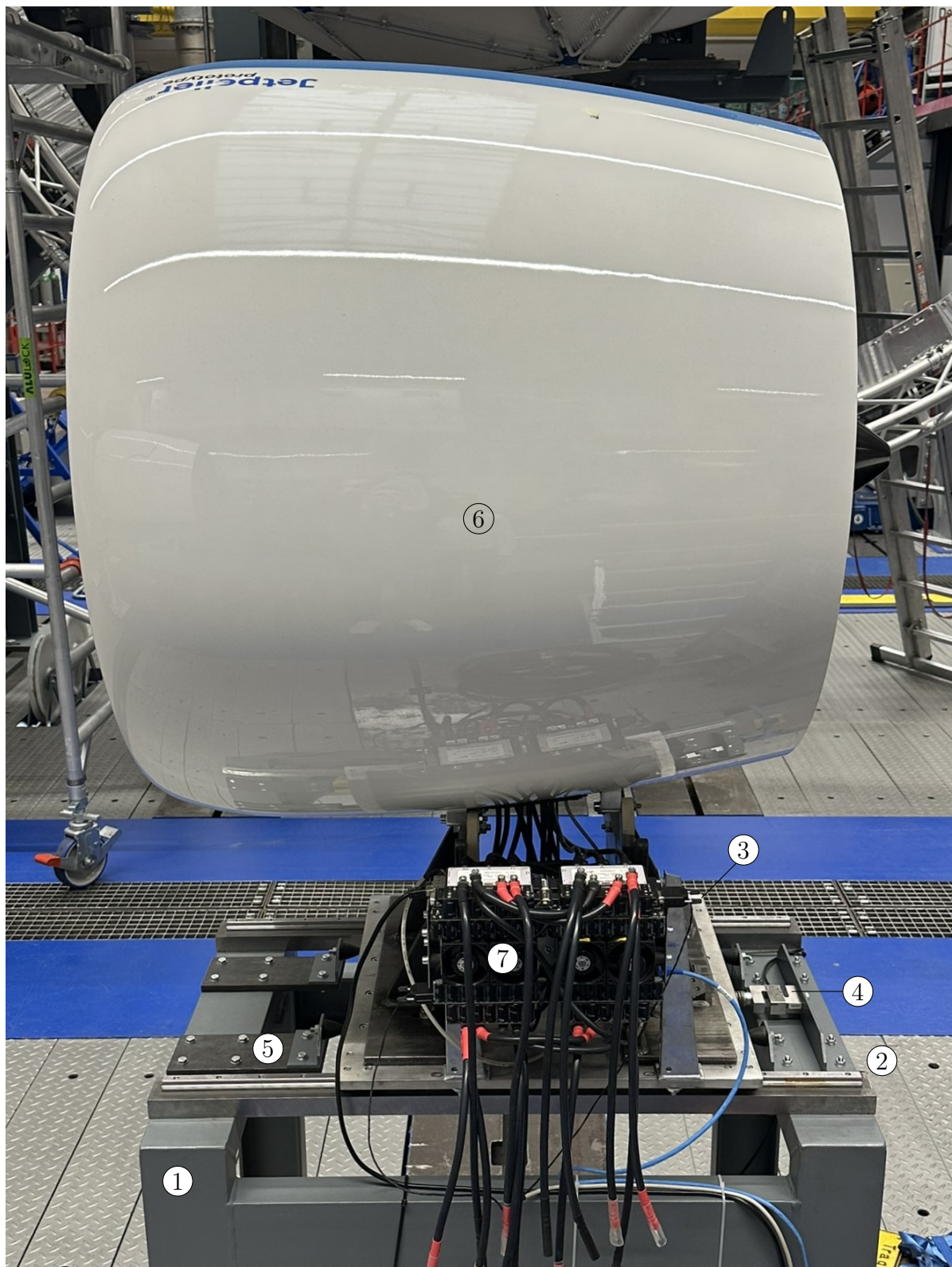
Abbildung 4.10.: Aufbau des Schubmessprüfstands
