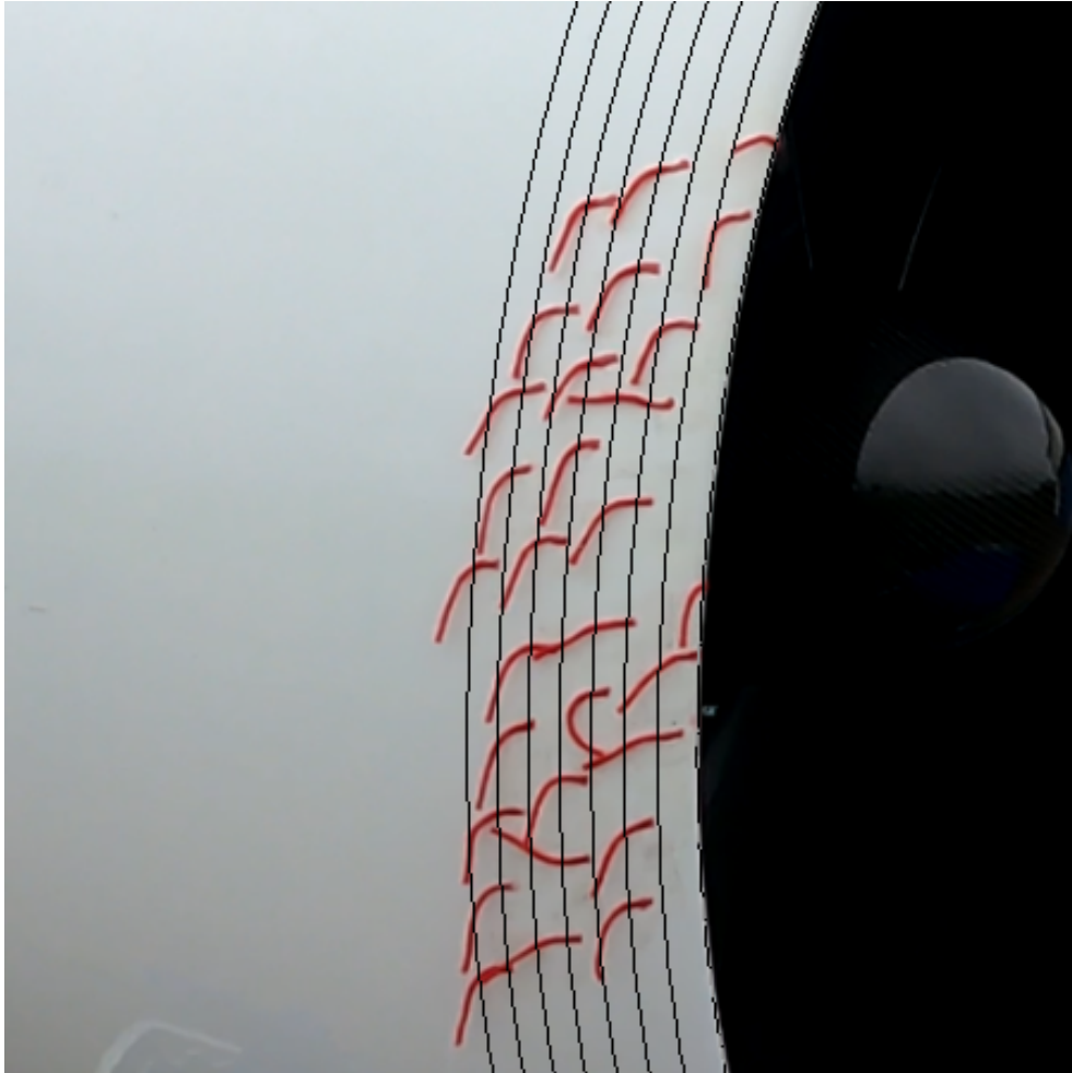
Abbildung B.4.: Überlagerung des Rasters aus aufgeklebten Wollfäden mit dem CAD-Modell zur Prüfung der einzelnen Positionen
