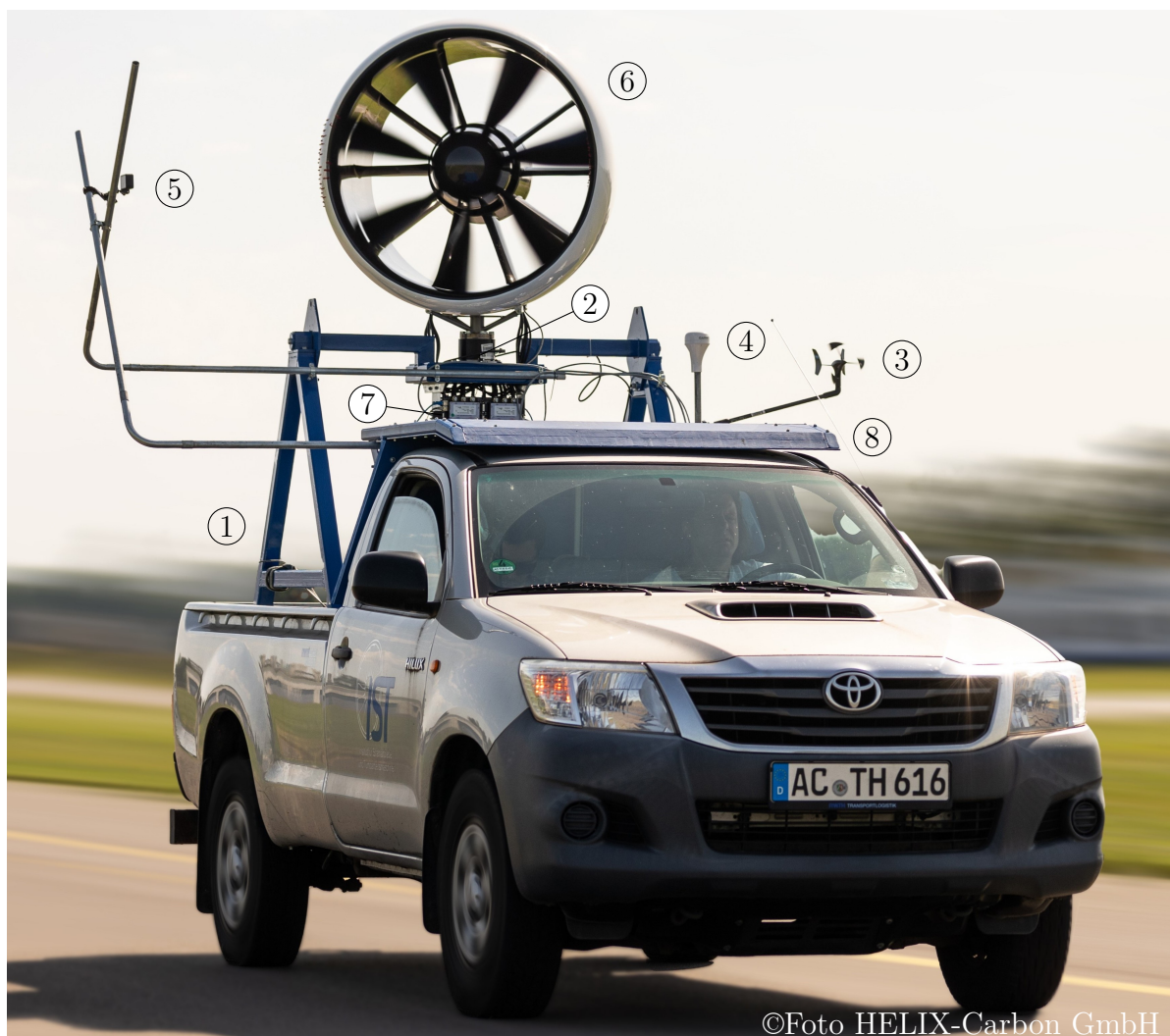
Abbildung 4.11.: Aufbau des mobilen Schubmessprüfstands
