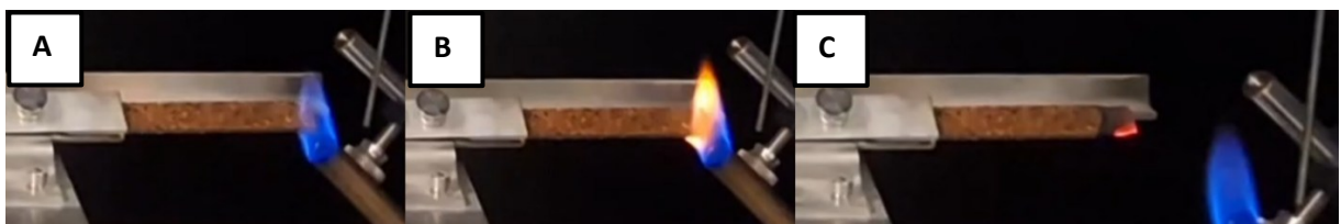
Abbildung 51: Mit Chitosanitaconat gebundene Miscanthusfaserplatte beim UL-94-HB-Brandtest zu Beginn der Beflammung (A), nach 30 Sekunden Beflammung (B) und nach Entfernen der Methangasflamme (C).
