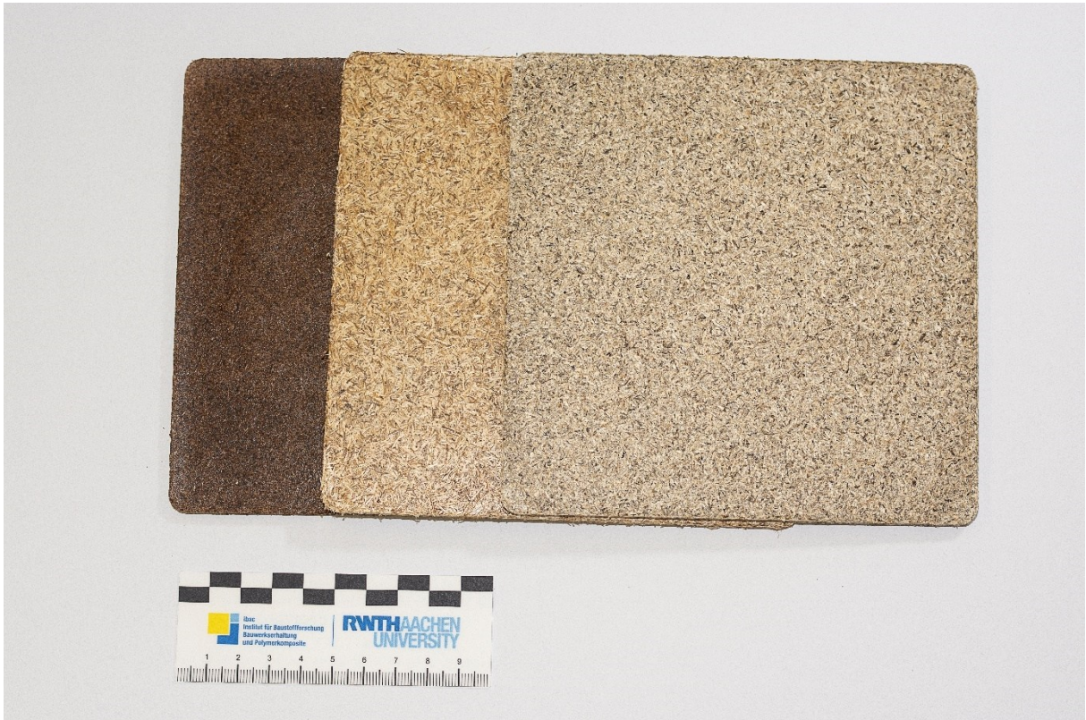
Abbildung 44: Mit Chitosanitaconat gebundene Staudenknöterich-, Miscanthus-, Hanf -Faserplatte (von links nach rechts).
