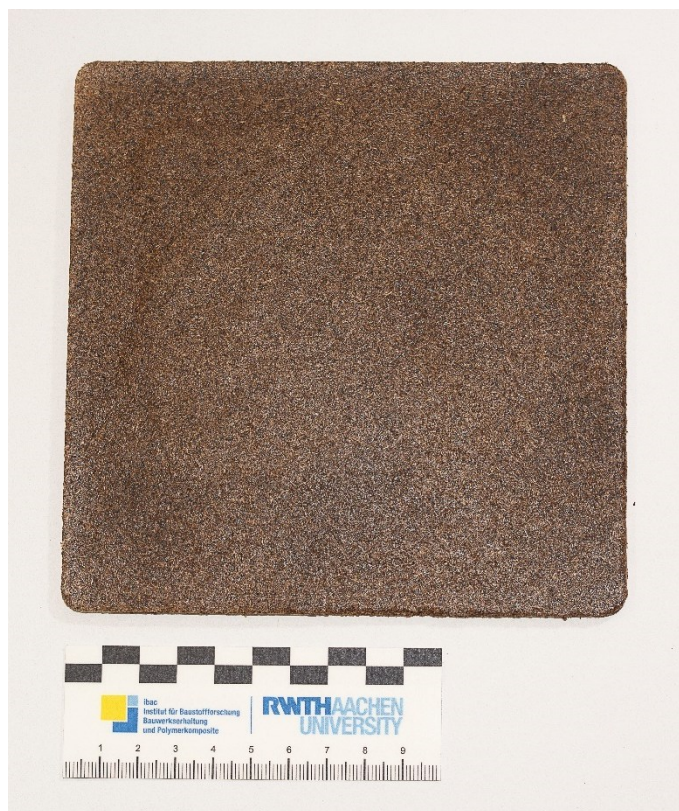
Abbildung 38: Mit 5 Gew.% Chitosanitaconat gebundene Miscanthusfaserplatte nach einer Heißpressung bei 125 °C.
