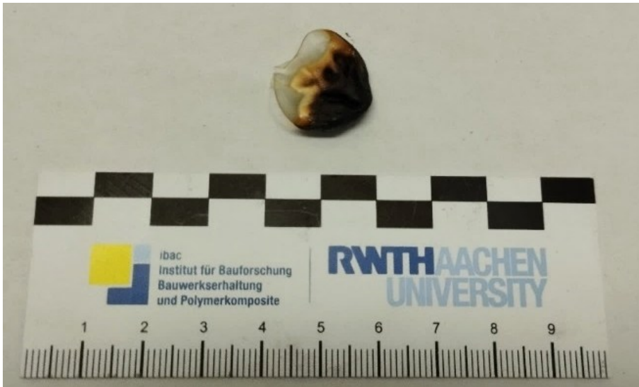
Abbildung 45: Chitosanitaconat-Film nach dem Beflammen mit einem Feuerzeug, wobei der Film verkohlt, aber nicht brennt.
