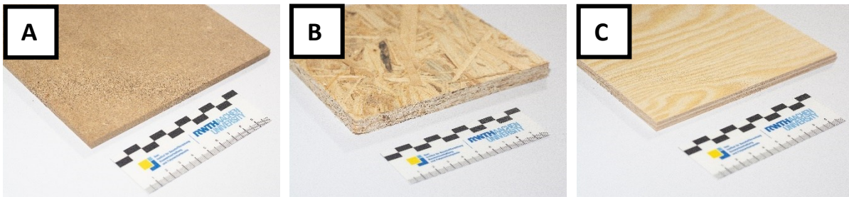
Abbildung 3: Mitteldichte Faserplatte (MDF, A), Grobspanplatte (OSB, B) und Sperrholzplatte (C).
