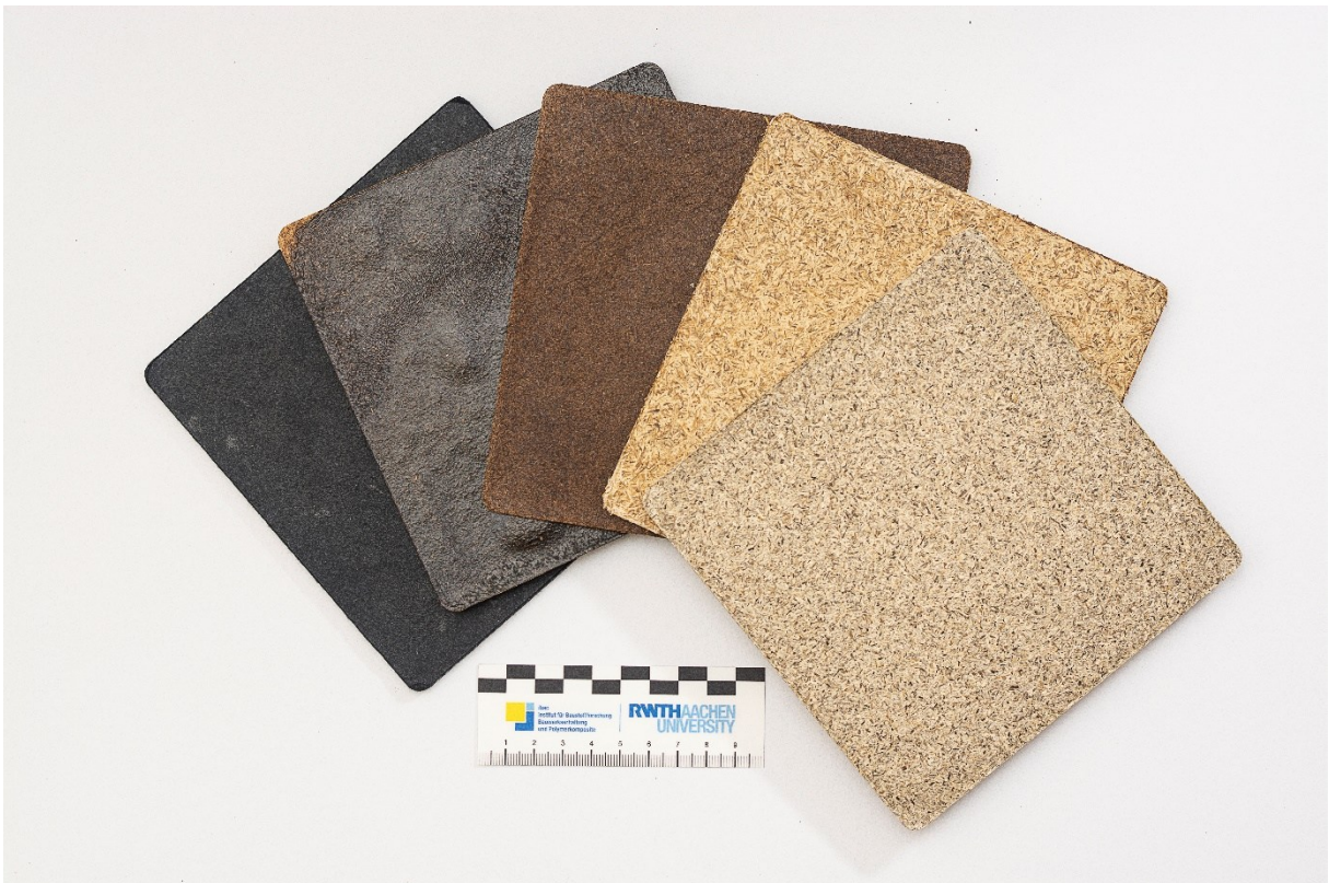
Abbildung 53: Faserplatten auf Basis des Chitosanitaconat-Bindemittels und pflanzlicher bzw. textiler Reststoffe (von rechts nach links): Hanfschäben, Miscanthusfasern, japanischer Staudenknöterichstielen, Zuckerrübenhackschnitzel sowie recycelte Baumwollalttextilien.
