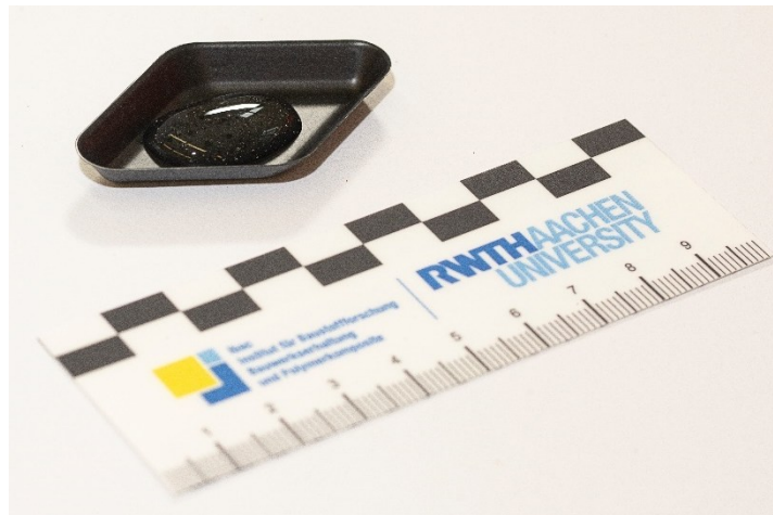
Abbildung 13: Tropfen einer 2,5 Gew.% Chitosanitaconat-Lösung in einem Wägeschälchen. Die Probe zeigt keine Fließneigung aufgrund ihrer erhöhten Viskosität.
