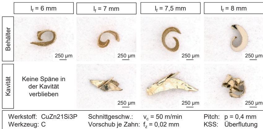
Abbildung 5.4: Spanformen in Abhängigkeit von der Eintauchtiefe l_f in der tauchgefrästen Kavität und im Spänebehälter
