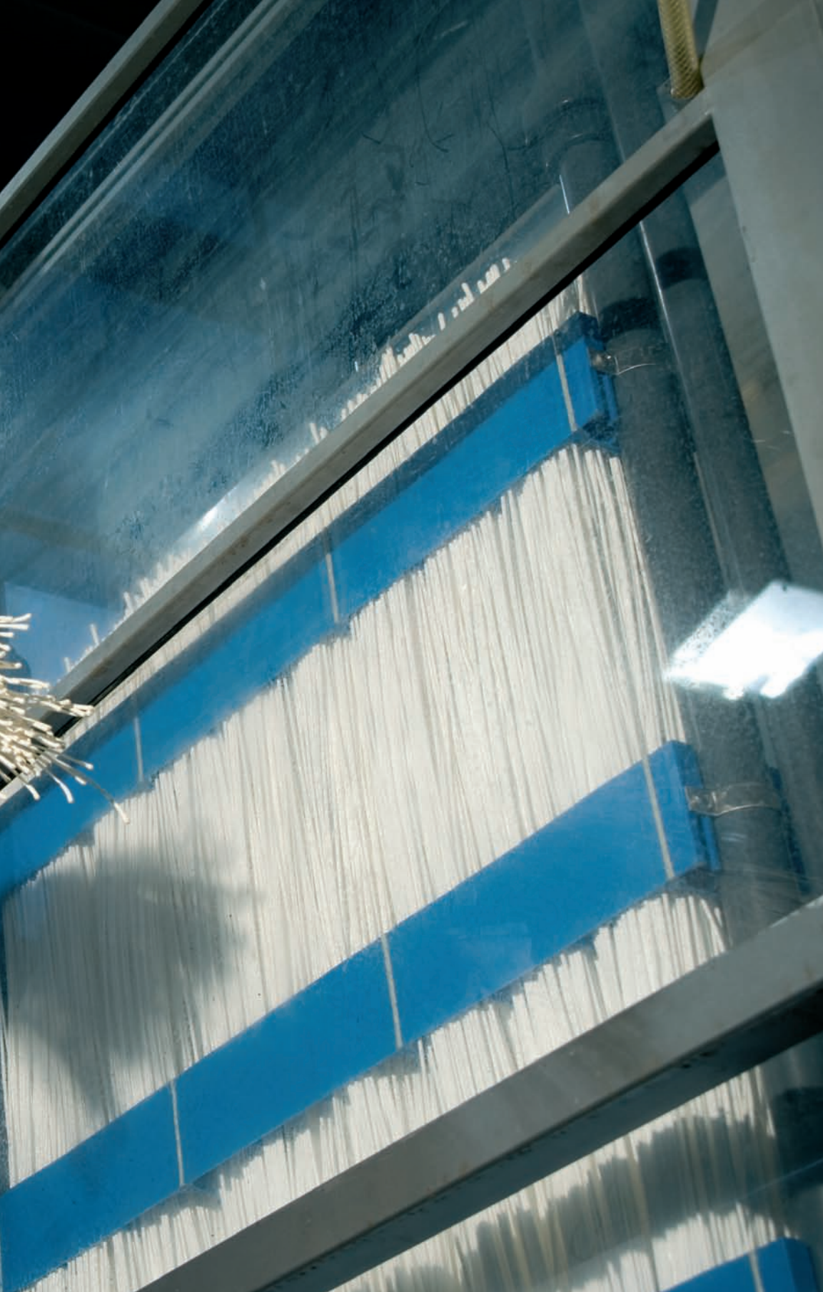
Bild 5: Wissenschaftler der Aachener Verfahrenstechnik (AVT) inspiziert ein Bündel verbrauchter Hohlfaser-Membranen. Im Hintergrund ist ein Membran-Modul zu sehen, in dem Bündel von Hohlfaser-Membranen für den Einsatz in Membran-Bioreaktoren eingebaut werden. Foto: Peter Winandy
