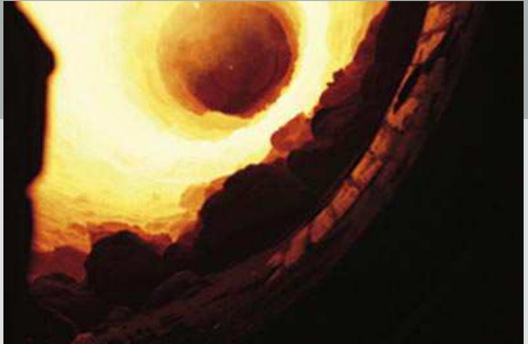
Bild 1: Innenansicht eines Drehrohrrofens im Betrieb.
