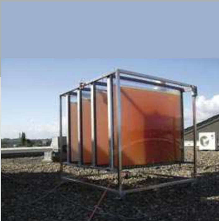
Bild 2: Fotobioreaktor im Freilandversuch auf dem Dach des AVT-Gebäudes.
