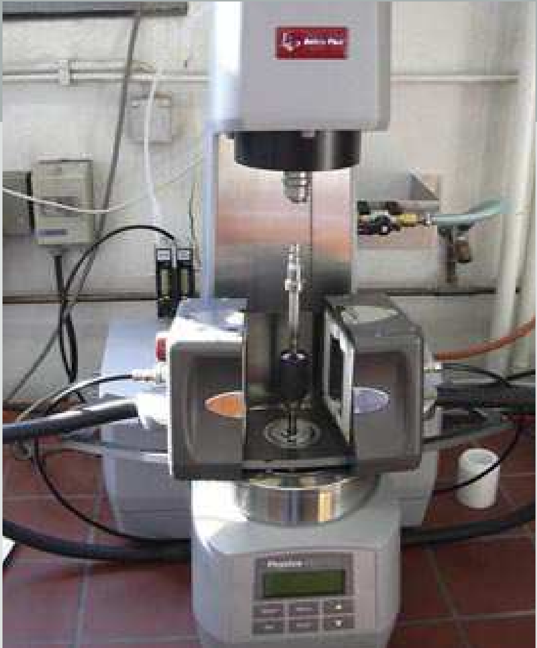
Bild 2: Dieses Hochtempera- turrheometer erlaubt die Untersuchung flüssiger Metalllegierungen bis 1000° C.
