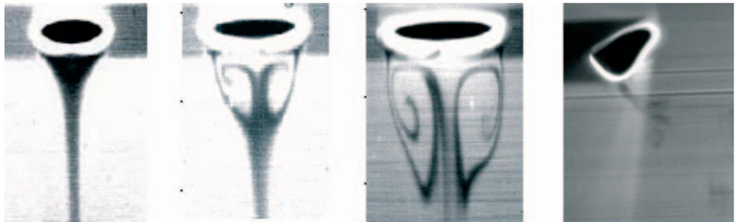
Bild 1: Experimentelle Aufnahmen des Sauerstoffgehaltes in Blasenschleppen bei unterschiedlicher Nachlaufform. Die regellose Blase rechts ist verkleinert dargestellt. Quelle: Institut für Umweltverfahrenstechnik, Universität Bremen.
