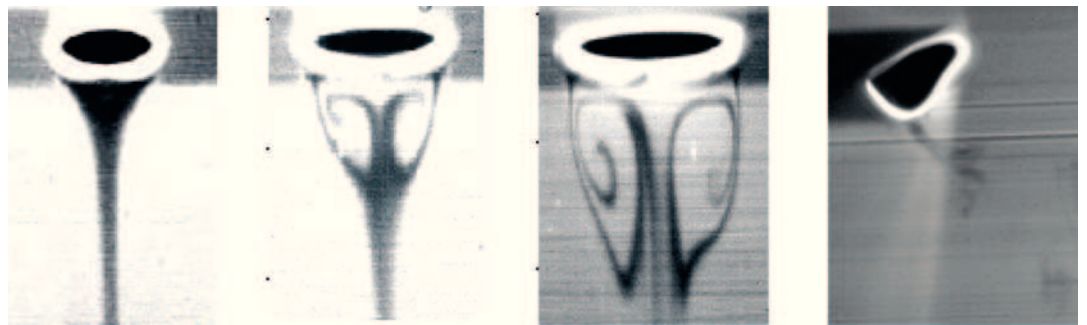
Bild 1: Experimentelle Aufnahmen des Sauerstoffgehaltes in Blasenschleppen bei unterschiedlicher Nachlauform. Die regellose Blase rechts ist verkleinert dargestellt. Quelle: Institut für Umweltverfahrenstechnik, Universität Bremen.
