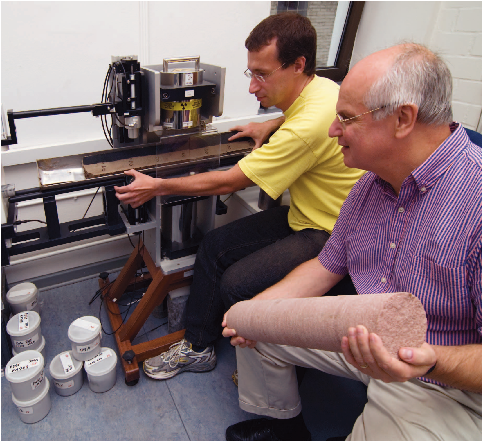
Bild 6: Univ.-Prof. Dr. rer. nat. Christoph Clauser und Dirk Breuer untersuchen Bohrkerne an einem Multisensor-Core-Logger, einem Messgerät für geophysikalische Messungen an Bohrkerne. Foto: Peter Winandy
