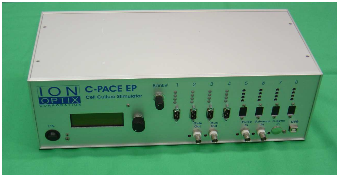
Abbildung 3: Steuergerät C-Pace EP von Ion Optix Corporation (The Netherlands) zur hochfrequenten Stimulation der Zellkulturen.
