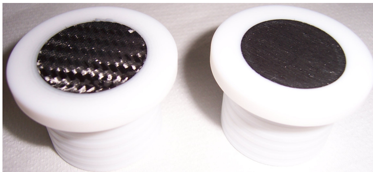
Bild 6.5.: C/C-Probenkörper für die senkrechte (links) und für die parallele (rechts) Diffusionsflusskonfiguration nach dem Zusammenbau mit ihren Teflon-Probenhaltern
