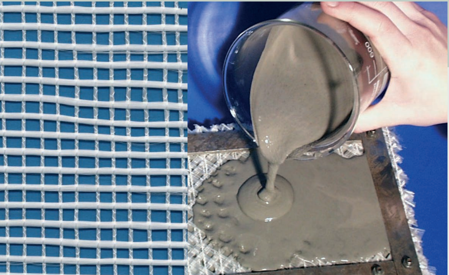
Bild 1: Bauteil (links), Glasfasertextil (Mitte), Feinbeton (rechts).
