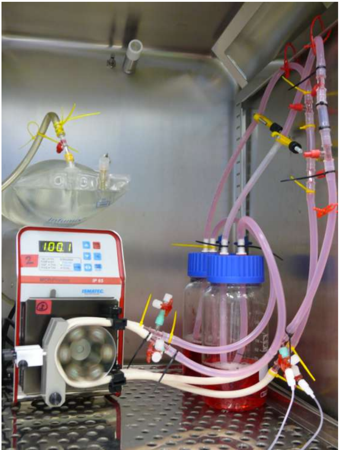
Abbildung 2: Kultivierung eines mit Zellen besiedelten Scaffolds im Bioreaktor
