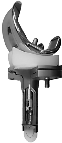
Abbildung 2.14: Schnittmodell eines instrumentierten Knieimplantats zur Kraftmessung (bearbeitet aus [AHSR08]).
