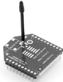
Abbildung B.3: XBee Modul mit Drahtantenne
