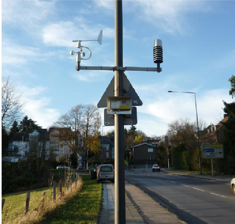
Abb. 22: Station KBR am 19.11.2009 mit Wind- und Thermo-Hygro-Geber in 3 m ü. Gr. (Blickrichtung: NW); Hintergrund: Bebauung entlang der Lütticherstraße (vgl. Abb. 20).
