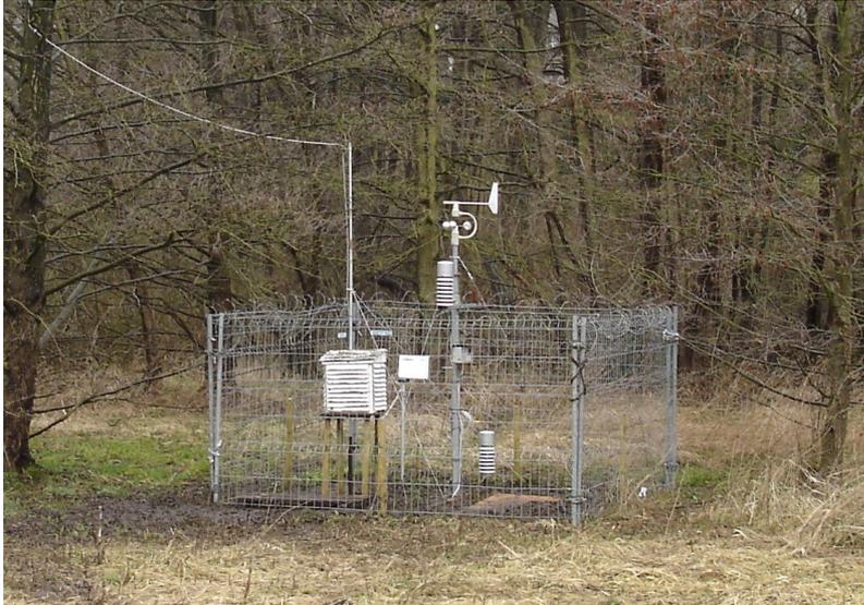
Abb. 23: Station KW am 25.03.2009 mit dem Windgeber in 3 m ü. Gr. sowie den Thermo-Hygro-Gebern in 2,5 m ü. Gr. und 0,5 m ü. Gr. (Blickrichtung: NW).
