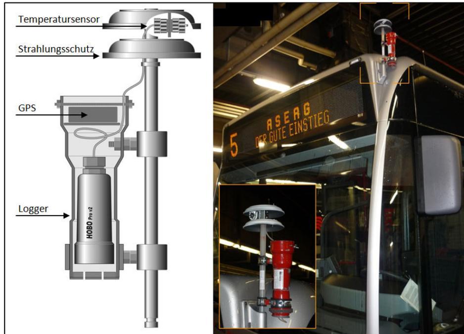
Abb. 34: Messeinheit mit Temperatur und GPS Logger (links) sowie deren Montage an einem Linienbus (ASEAG) in Aachen (Grafik links: EHRIG, A., Geographisches Institut, RWTH Aachen)
