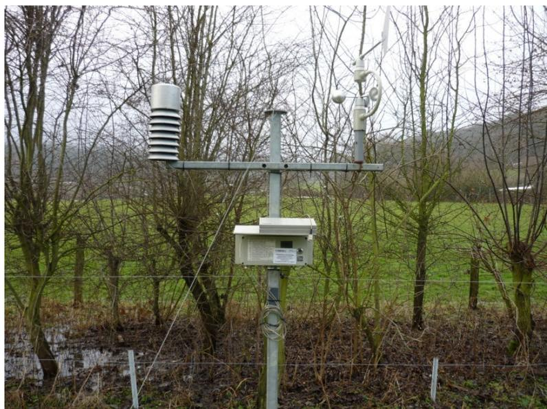
Abb. 25: Station JH am 18.01.2010 mit Wind- und Thermo-Hygro-Geber in 2,5 m ü. Gr. (Blickrichtung: SW).
