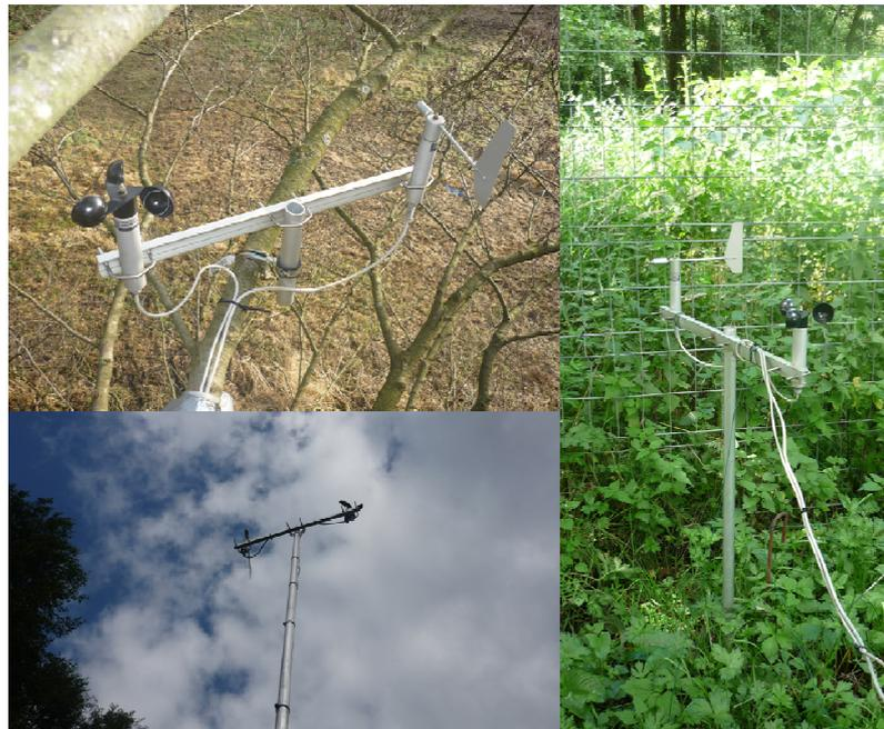
Abb. 24: Station KB in einer Messhöhe von 5,5 m ü. Gr. im Baum in Messzeitraum 1 (oben links, vgl. Kap 5.1.3, 08.02.2010) und am Mast in Messzeitraum 2 (unten links, vgl. Kap. 5.1.3, 15.09.2010) sowie Station KB (1 m) (rechts, 03.08.2009).
