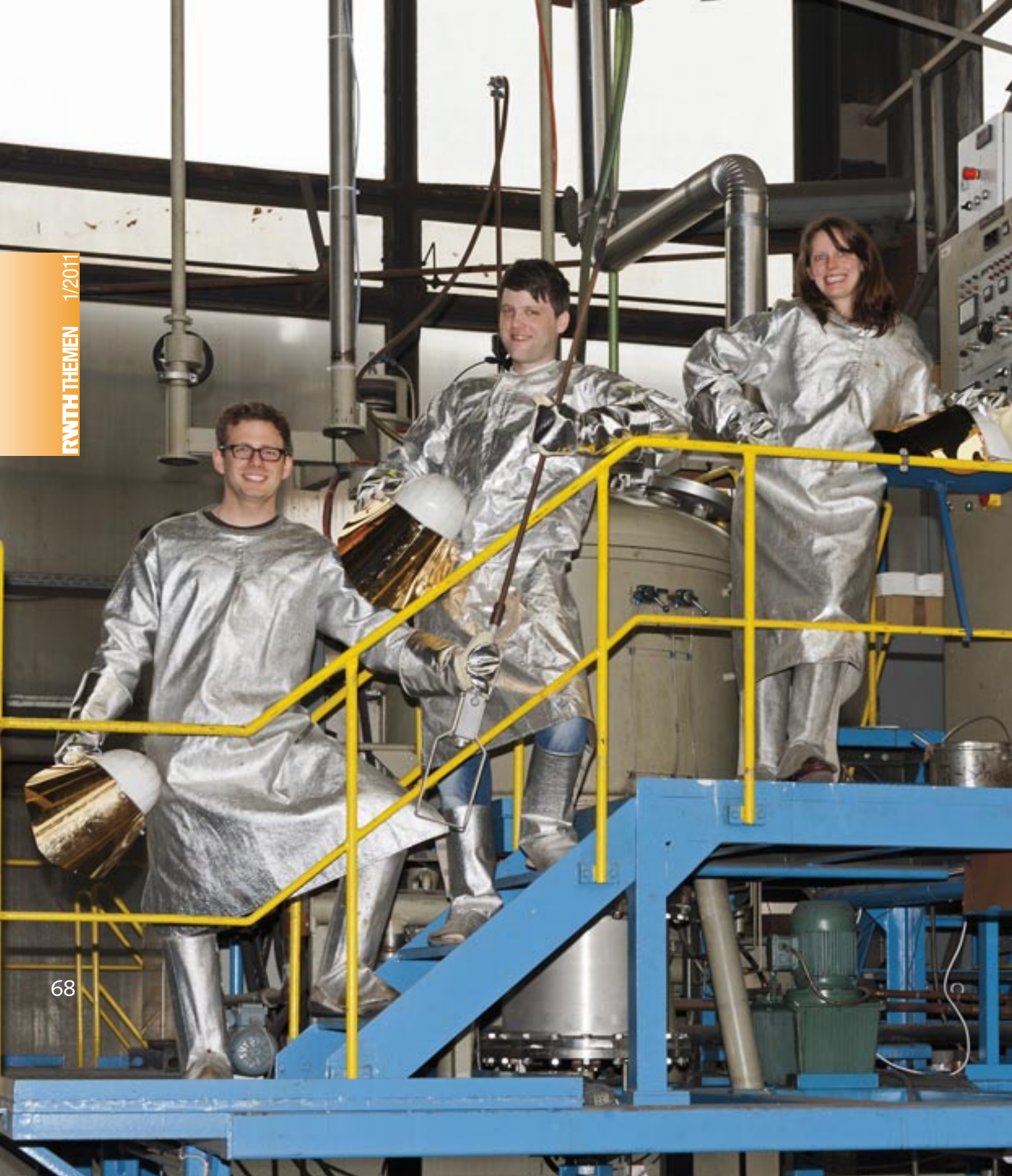
Bild 1: Im Hintergrund ein Vakuuminduktionsofen zur Herstellung hochreiner Stähle am Institut für Eisenhüttenkunde. Die Wissenschaftlichen Mitarbeiter des Lehrstuhls tragen bei Schmelzversuchen Sicherheitskleidung. Foto: Peter Winandy
