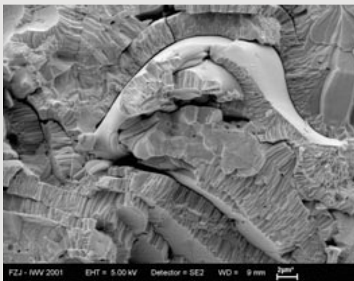
Bild 1: Rasterelektronenmikroskopische Aufnahme einer Bruchfläche einer YSZ-Wärmedämmschicht.
