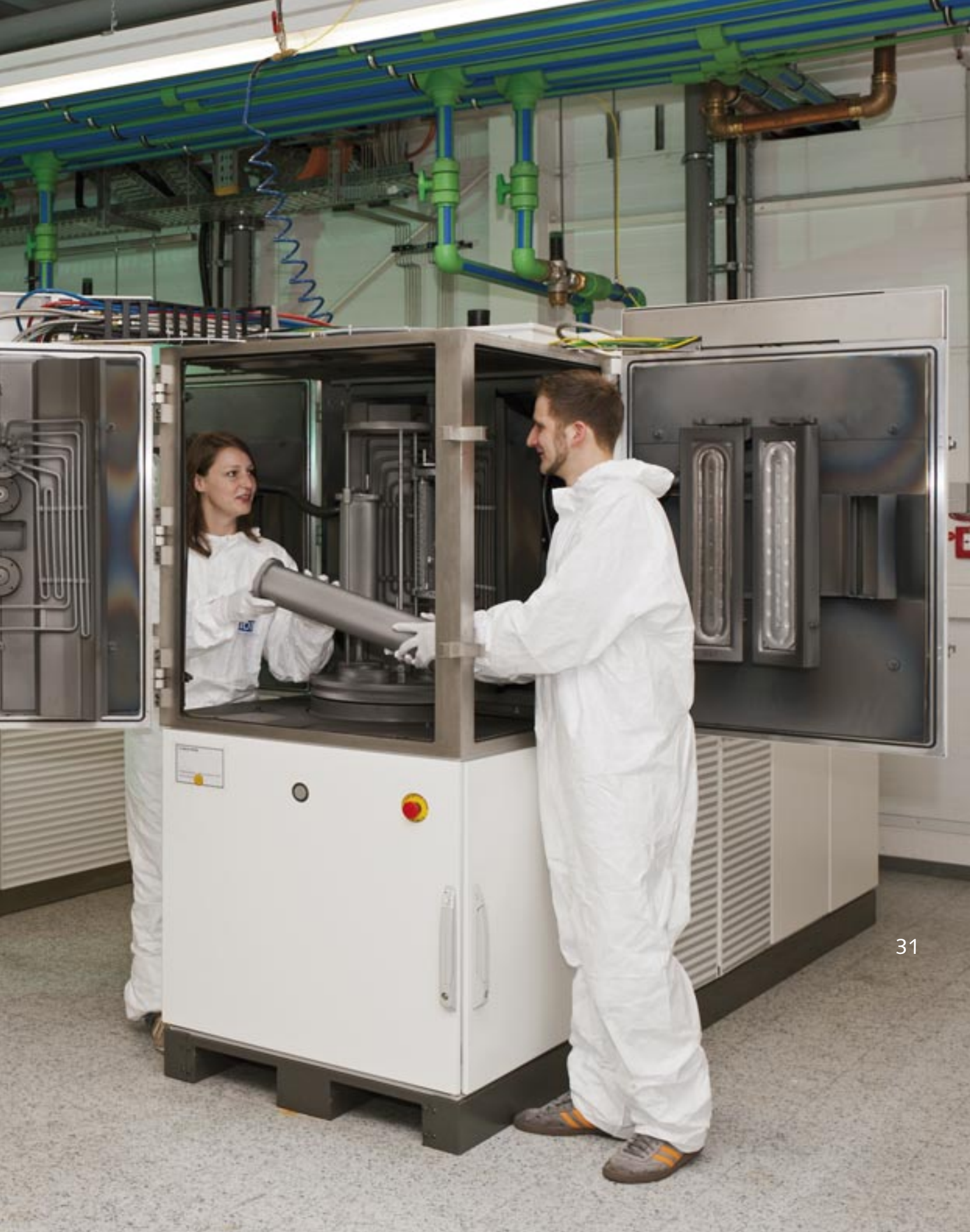
Bild 3: Den Forschungsinstituten stehen speziell für dieses Vorhaben ausgestattete industrielle Hochleistungsplasmabeschichtungsanlagen zur Verfügung. Foto: Peter Winandy
