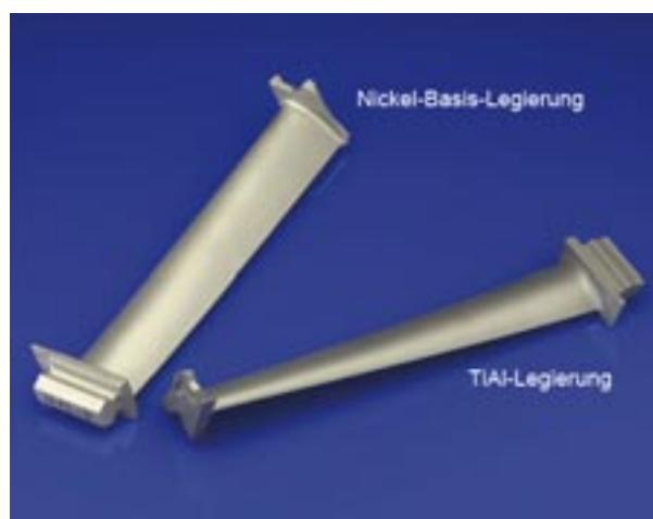
Bild 2: Niederdruckturbinenschaufeln aus Titanaluminid und aus einem Nickelbasiswerkstoff. TiAl-Werkstoffe weisen gegenüber Nickelbasiswerkstoffen eine bis zu 50 Prozent geringere Dichte auf. So lässt sich das Gewicht der gesamten Flugturbinen reduzieren. Diese Maßnahmen sind die Basis für angestrebte Einsparungsziele wie die Verringerung des Treibstoffverbrauchs sowie die Reduzierung von Abgas- und Geräuschemissionen. Quelle: Access e.V.
