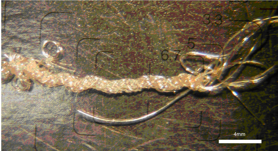
Abb. 10: PU Stent erster Generation: PU Stent (12 Monofilamente, 200µm Monofilamentdurchmesser, 45°C Flechtwinkel, 2fache Verstreckung) nach 1stündiger Inkubation bei 37°C.
