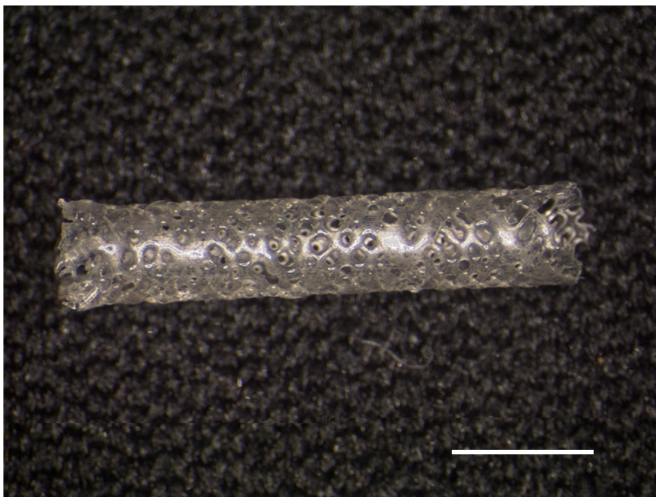
Abb. 11: PU Stent zweiter Generation: PU Stent (12 Monofilamente, 100µm Monofilamentdurchmesser) nach Wärmebehandlung bei 125°C (Maßstabsbalken = 3mm).
