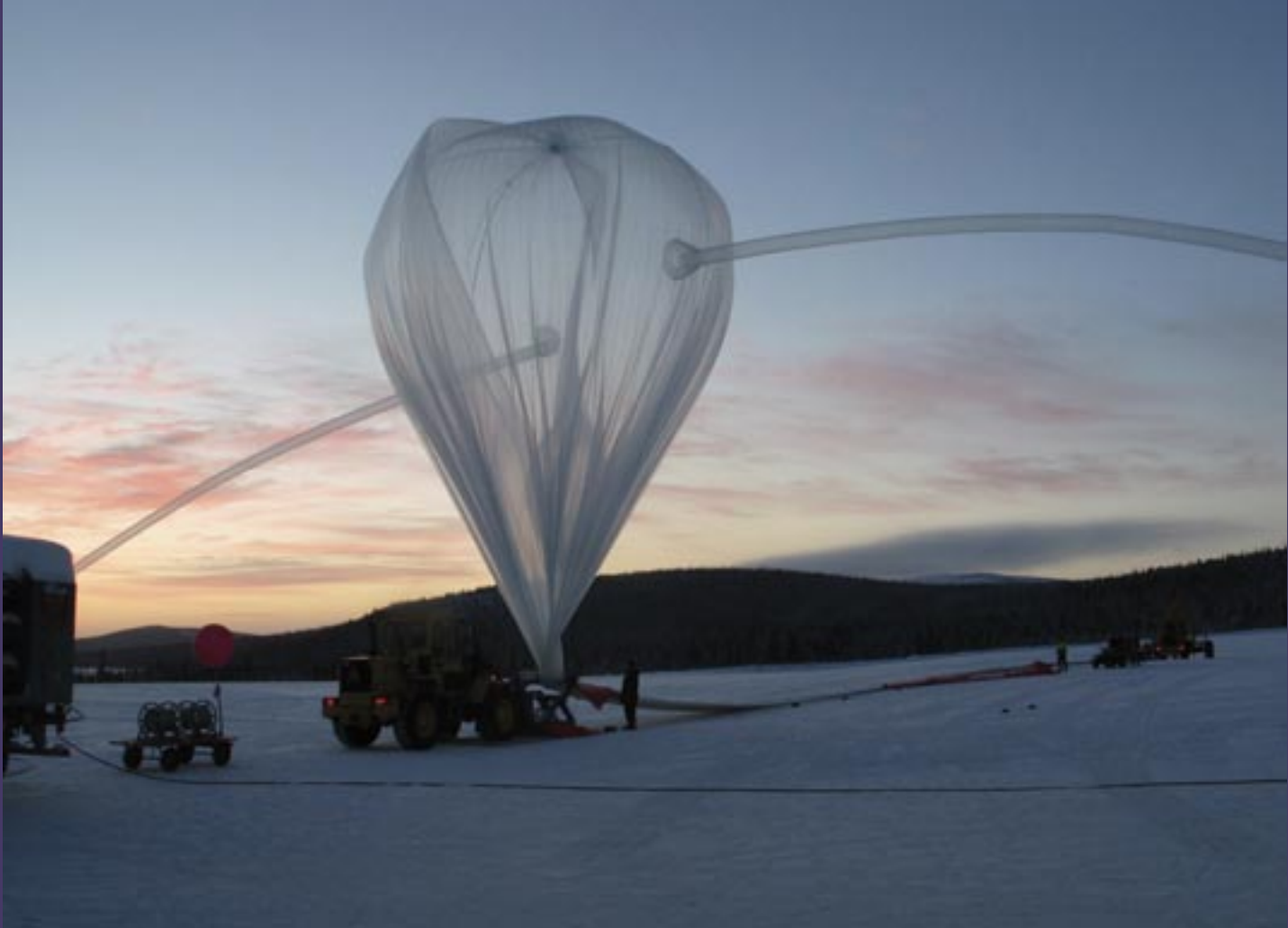
Der Ballon BEXUS 11 wird mit Gas befüllt, bevor er mit einem RWTH-Experiment an Bord in die Stratosphäre aufsteigt. Foto: DLR
