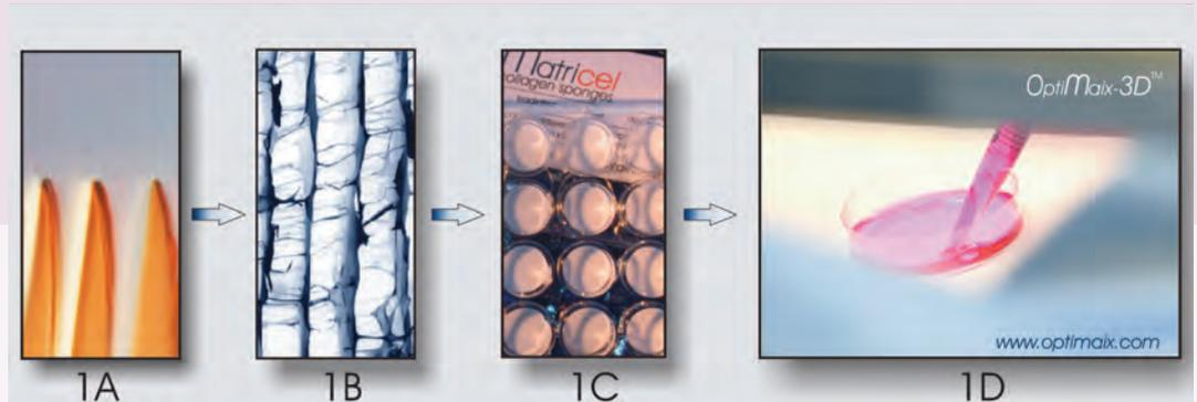
Bild 1: Das strukturierte Biomaterial aus Kollagen wird hergestellt durch das Wachstum von fingerförmigen Eiskristallen, hier gelb dargestellt, durch eine Kollagendispersion (1A).
