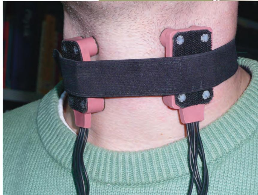
Bild 2: Elektrodenarray zur Abtastung von bis zu 36 verschiedenen Strompfaden.
