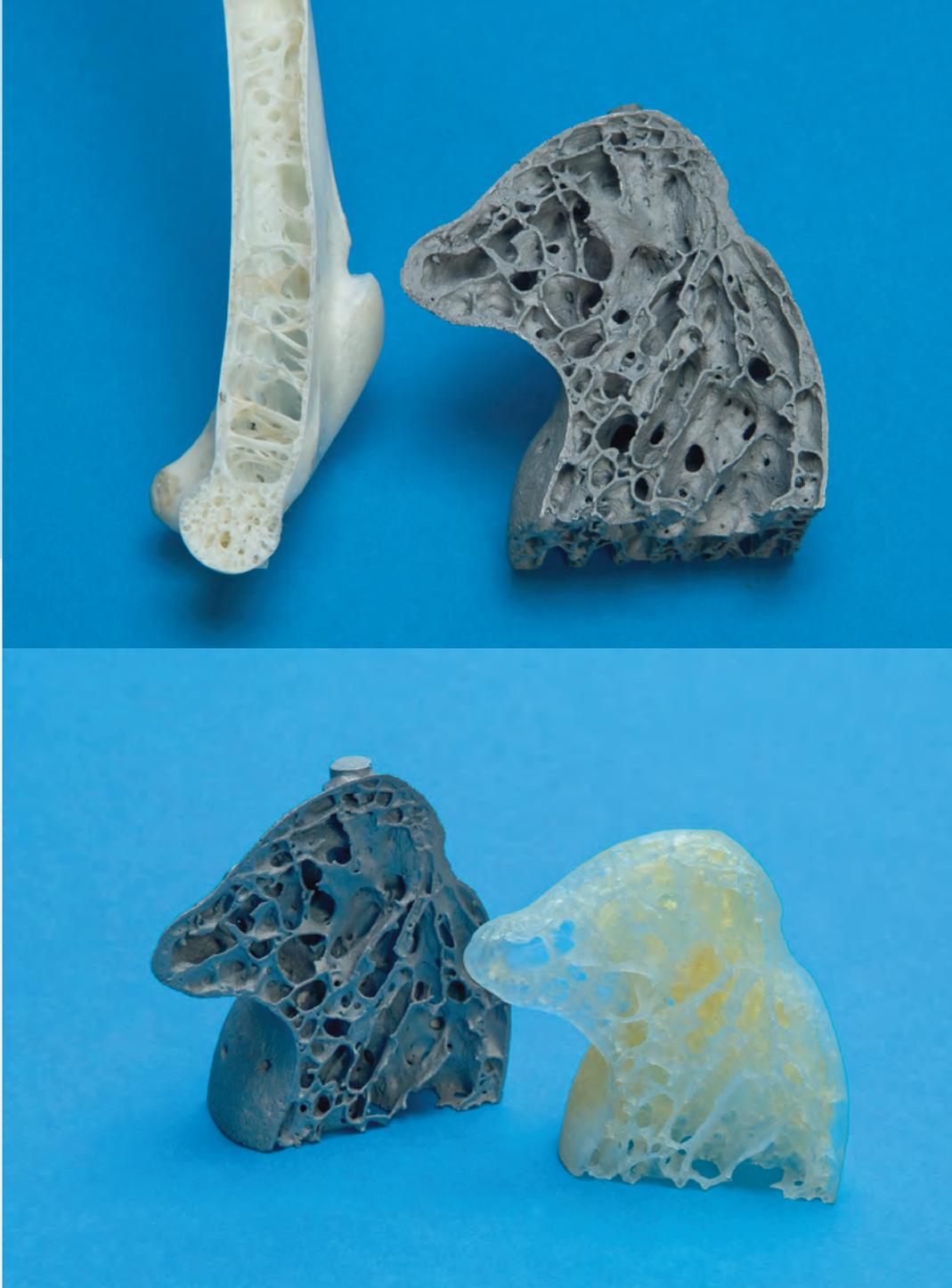
*Bild 2: Replikation der Strukturen eines Pelikanknochens in einem metallischen Gussteil. Die mittels Computertomographie vermessene und erfasste Geometrie wird durch ein Ra-*
