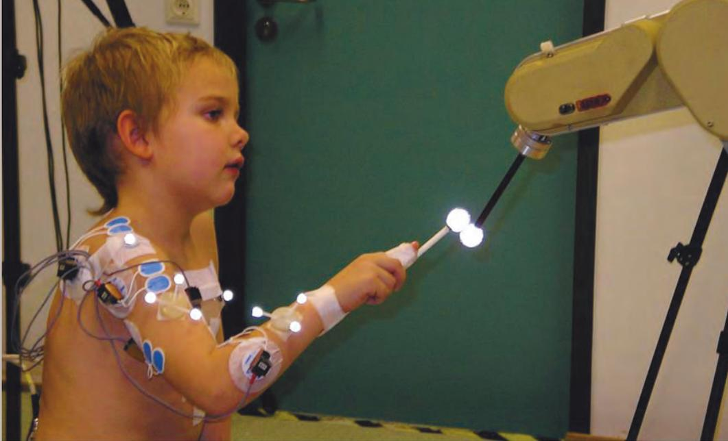
Bild 2: 3D-Tracking zur standardisierten und reproduzierbaren Erfassung der Bewegungen oberer Extremitäten. Ein Roboter gibt eine dreidimensionale Bewegungsbahn vor, der der Patient folgen muss. Eine spezielle Sensorik erfasst die Qualität der Bewegungsdurchführung.
