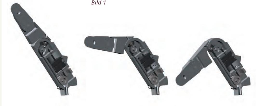
verfügt über insgesamt elf voneinander unabhängige Bewegungsmöglichkeiten: Die beiden äußeren Finger und der Daumen verfügen über jeweils drei unabhängige Bewegungsmöglichkeiten, der Mittelfinger verfügt über deren zwei.
