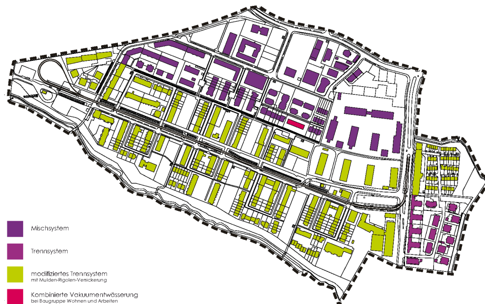
Abb. 27: Entwässerungssysteme auf dem Vauban Gelände
