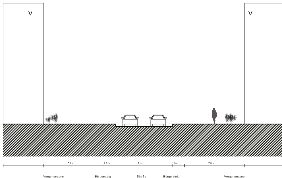
Abb. 12: Straßenquerschnitt Astrid Lindgren Straße, 2. Bauabschnitt
