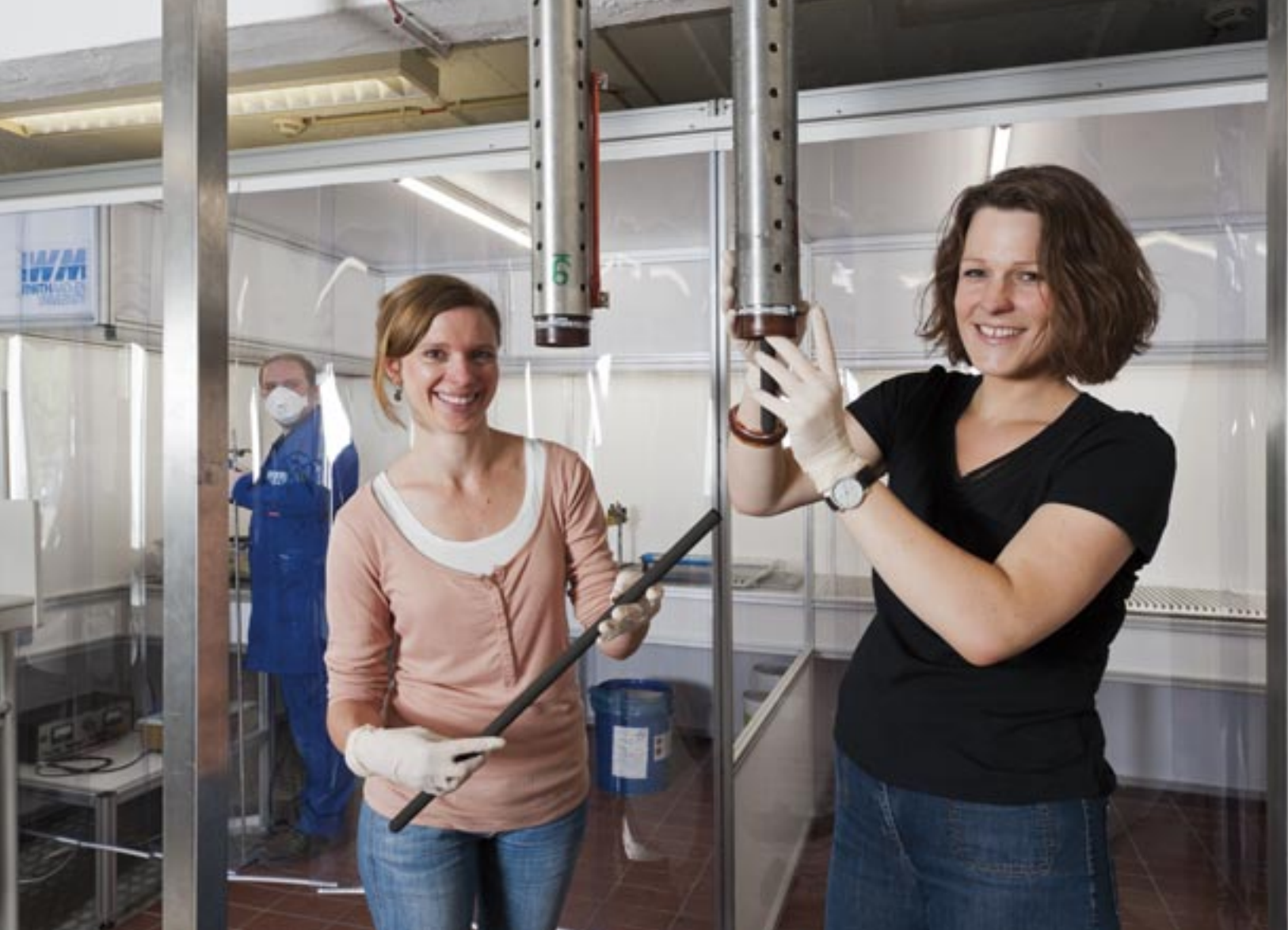
Bild 3: Nach dem isostatischen Pressen werden die keramischen Membranrohre aus den Pressformen entnommen. Danach müssen die Membranen die weitere Prozesskette (Grünbearbeitung, keramischer Brand,
