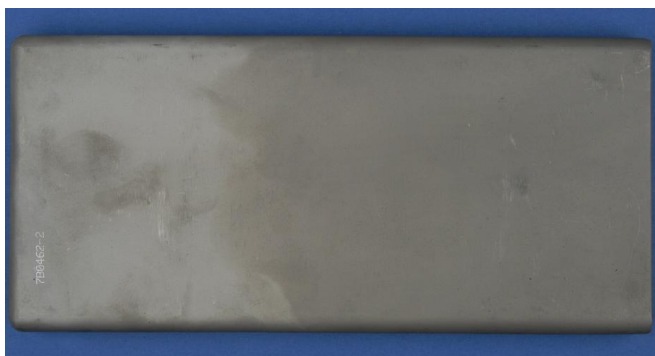
Abbildung 2.1: Gussplatte aus dem Werkstoff RENE 80.
