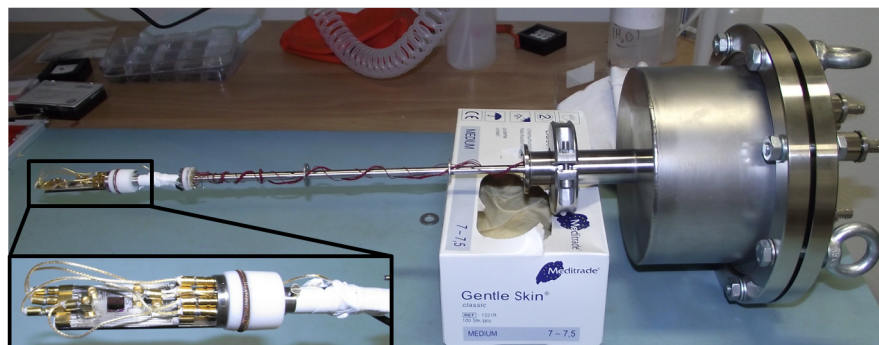
Abb. 5.9.: Chip-Carrier wird an den Cryostatenaufsatz angeschlossen.
