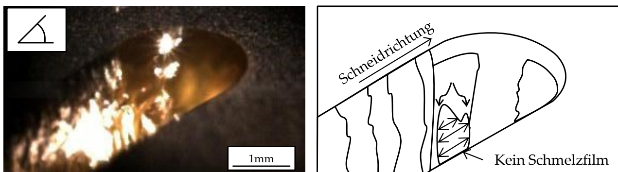
Abbildung 5.7: Entstehung von Riefen durch Fingerbildung der Schmelze
