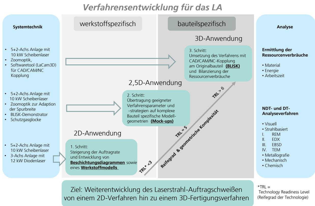
Bild 3: Flussdiagramm der den Untersuchungen zu Grunde liegenden Zielsetzung und der Vorgehensweise innerhalb der Verfahrensentwicklung
