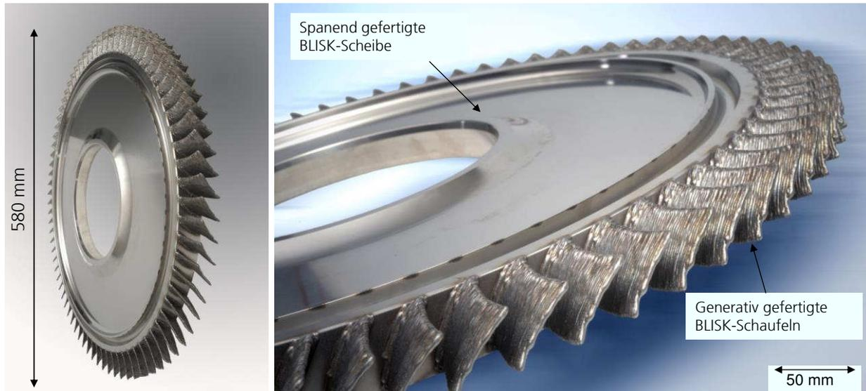
Bild 68: BLISK mit 76 Schaufeln; die Schaufeln wurden generativ mittels LA und die BLISK-Scheibe spanend gefertigt
