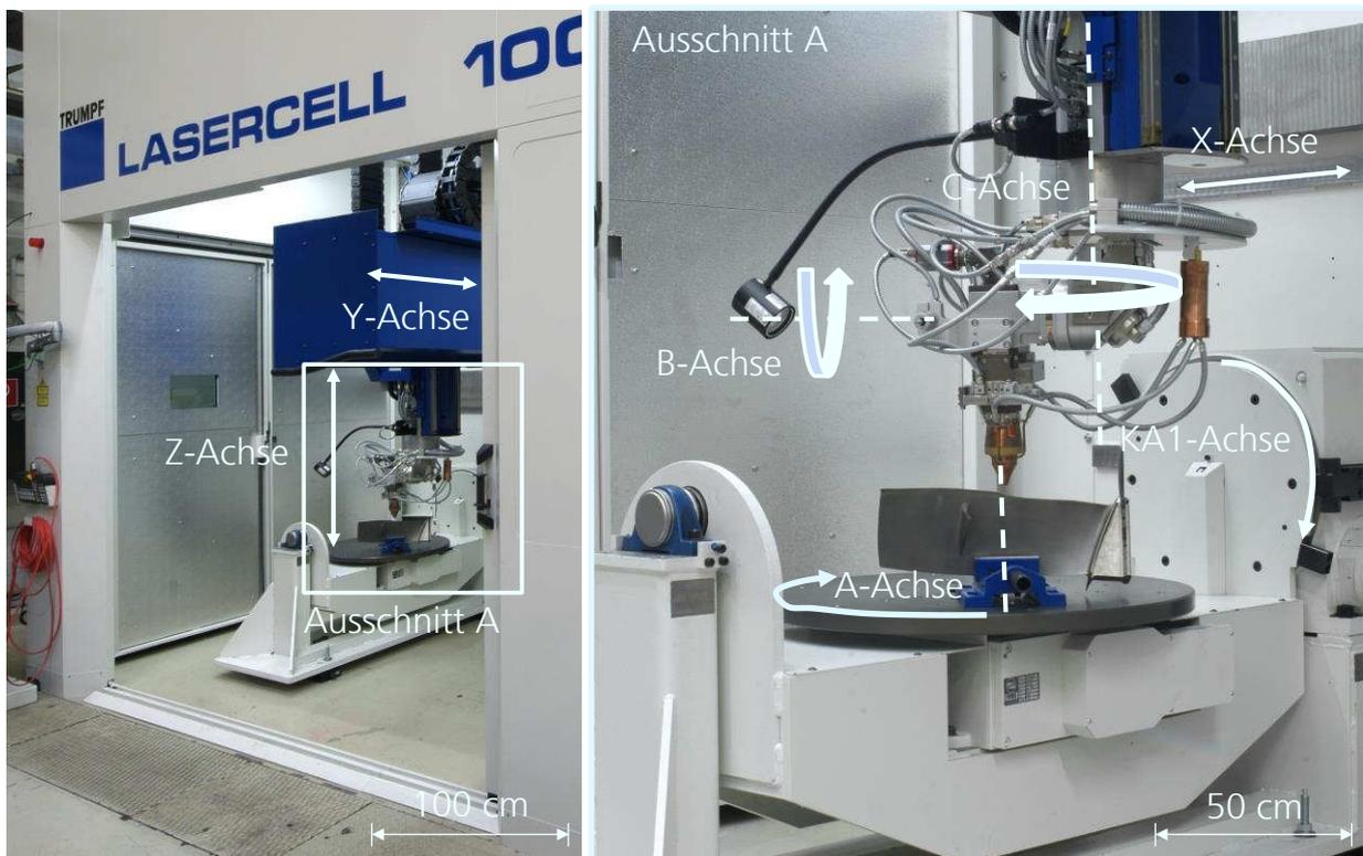
Bild 9: 5+2-Achs-Anlage Trumpf Lasercell 1005
