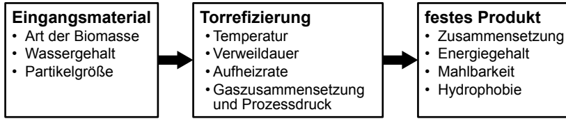
Abbildung 3.2: Wesentliche Parameter des Eingangsmaterials, des Torrefizierungsprozesses und der relevanten Produkteigenschaften
