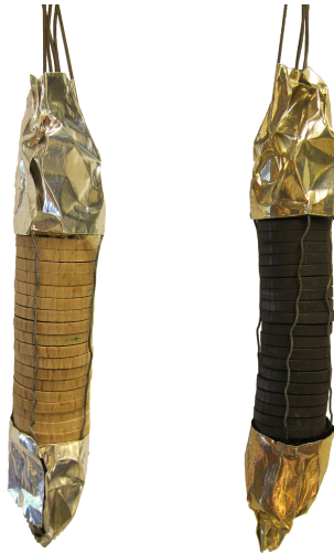
Abbildung 4.17: Foto des aus 20 gestapelten Scheiben bestehenden Probenzylinders für einen Versuch mit radialer Erwärmung vor und nach der Torrefizierung (Durchmesser: 25 mm, Länge: ca. 70 mm)
