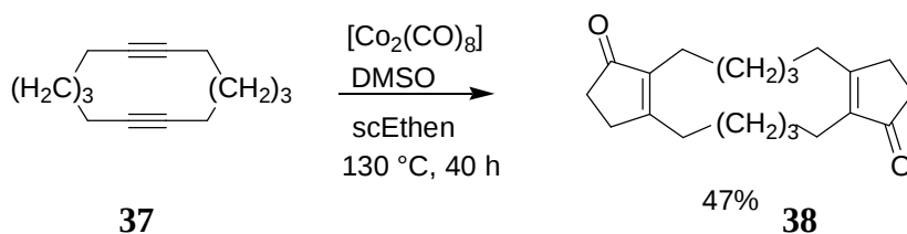
Schema 11. Pauson-Khand Reaktion in überkritischem Ethen [98]
