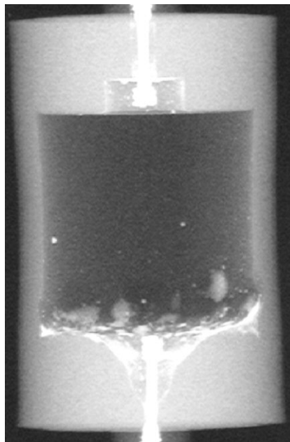
Abbildung 3.9: Röntgen-Schattenbild einer 70W Metallhalogenidlampe nach Betriebsdauer von 6000 Stunden in vertikaler Position [22]
