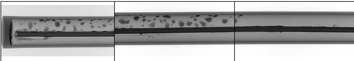
Abbildung 5.47: Röntgenbilder der Korrosionsampulle T1 in seitlicher Sicht auf die innere Platte nach 330 Stunden
