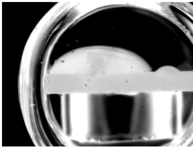
Abbildung 3.4: Photo eines Calciumjodidtropfens auf einer Platte umgeben von einer Gasphase aus Calciumjodid und Argon
