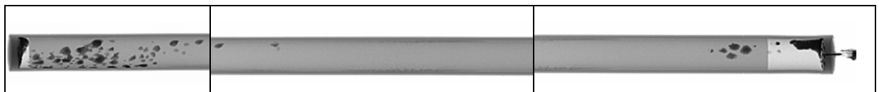
Abbildung 5.32: Röntgenbilder der Korrosionsampulle B9 in frontaler Sicht auf die innere Platte nach 330 Stunden
