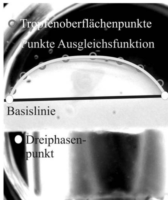
Abbildung 4.2: Schematische Darstellung der Kontaktwinkelbestimmung
