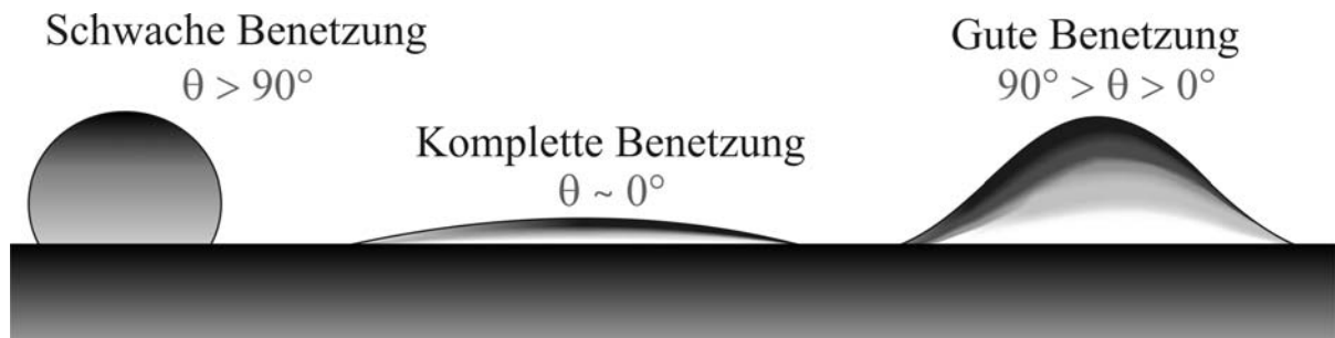
Abbildung 3.7: Schematische Darstellung von den drei Arten der Benetzung
