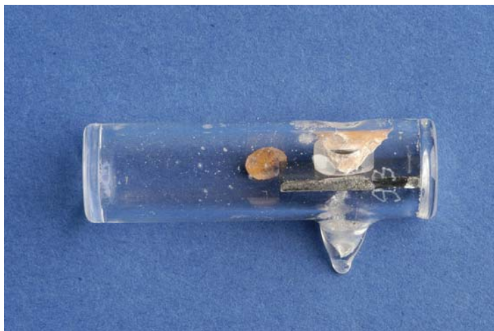
Abbildung 4.4: Bild einer Randwinkelampulle mit reinem CaI 2 und Kohlenstoffplatte
