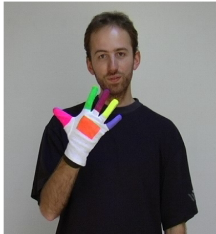
Abbildung 2.16: Beispiel eines farbig markierten Stoffhandschuhs zur Verwendung mit dem Gebärdensprachtutor. Die Markergeometrie kann an die Aufgabenstellung angepasst werden.
