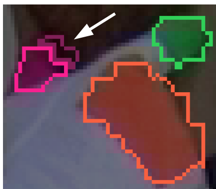
Abbildung 7.17: Fehlerhafte Segmentierung der Markerregionen in der Gebärde „Hals“ (vgl. Abbildung 7.16). Der Mean-Shift-Algorithmus detektiert irrtümlich den Mittelfingermarker am Rand des Daumenmarkers (Pfeil).
