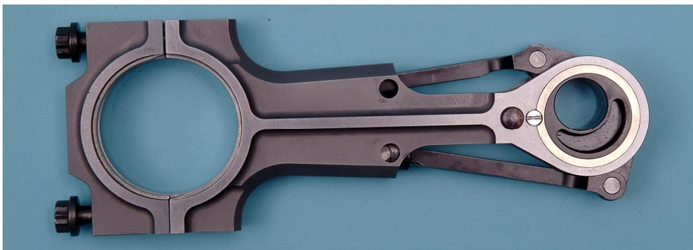
Bild 70: Montiertes VCR-Pleuel „Mehrzyklussteller“
