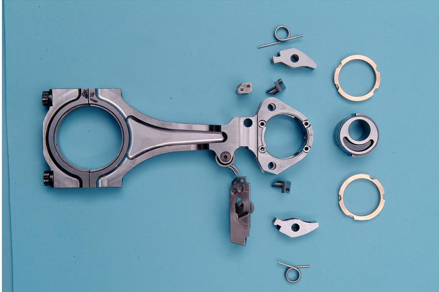
Bild 63: Bauteile VCR-Pleuel „Einzyklussteller“
