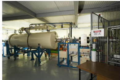
(a) Beschleuniger Japet für Erzeugung der verwendeten Au-Ionen.
