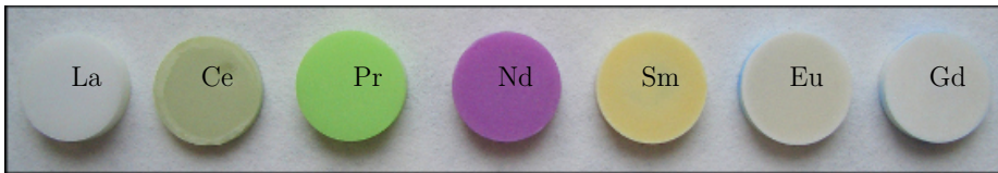
Abb. 4.2: Gesinterte (1500 °C) und polierte Pellets verschiedener Lanthanoidzusammensetzungen LnPO_4 ( Ln = La-Gd ).
