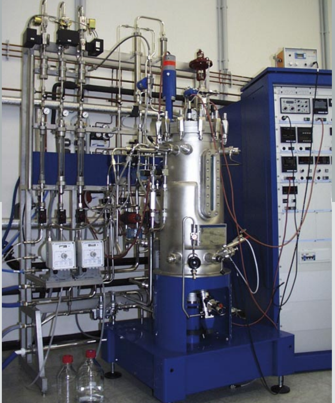
Bild 3: 50 Liter-Druckreaktor der Aachener Verfahrenstechnik für den Labormaßstab, der im wesentlichen dem späteren großtechnischen Produktionsreaktor entspricht.
