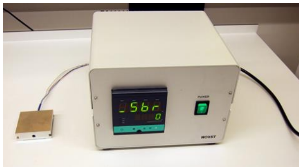
Abbildung 5.4: Heizplatte mit Temperaturregler HT560.
