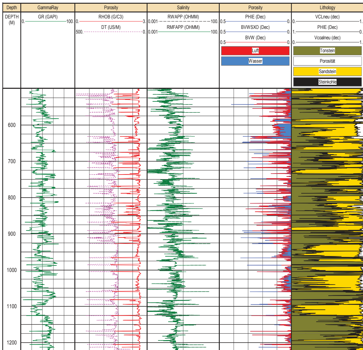
Abbildung 4.44: Ergebnis der petrophysikalischen Auswertung für die Bohrung B-17. GR: Gammaaktivität; RHOB: Gesamtdichte; DT: Laufzeit der Longitudinalwelle; RWAPP: scheinbarer Widerstand des Formationswassers; RMFAPP: scheinbarer Widerstand des Mud-Filtrats; PHIE: effektive Porosität; BVW: Gesamtwasservolumen; BVWSXO: Gesamtwasservolumen der saturierten Formation; VCLneu: Tonvolumen, berechnet aus GR; Vcoalneu: ausgewiesen durch Dichte-Cuttoff.
