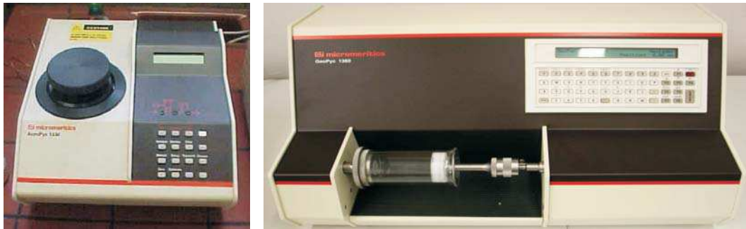
Abbildung 2.6: Anordnung der Dichte- und Porositätsmessung (aus Clauser et al., 2007). Links: Helium-Pyknometer zur Bestimmung der Reindichte der Probe. Rechts: Feststoff-Pyknometer zur Bestimmung der Rohdichte der Probe.
