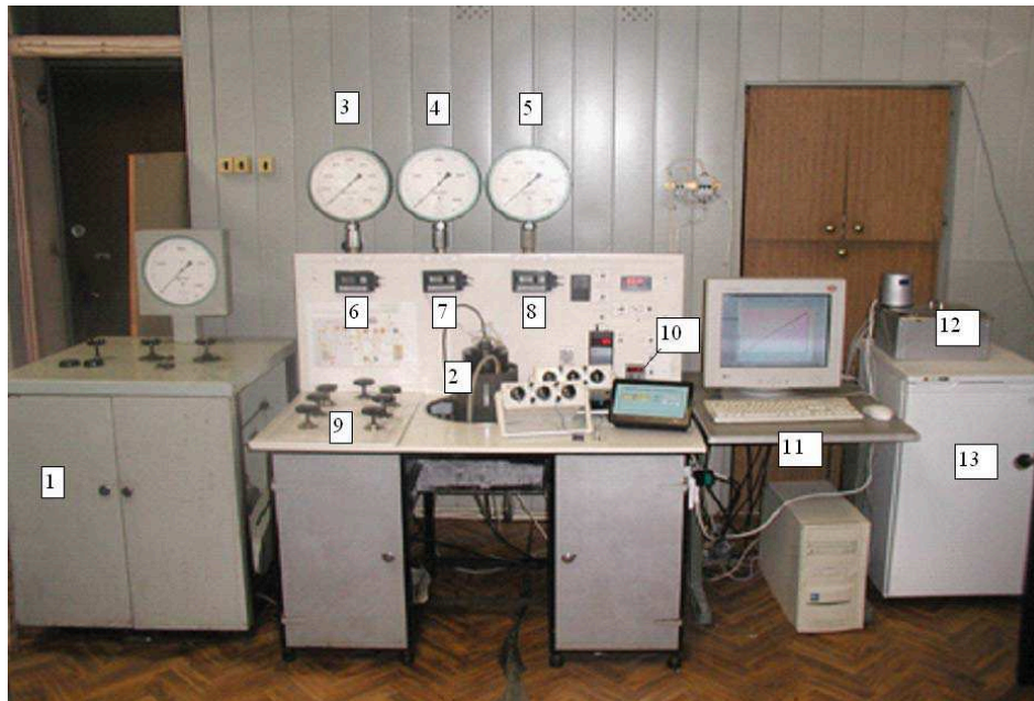
Abbildung 2.5: Apparatur zur druck- und temperaturabhängigen Messung von Wärmeleitfähigkeit, Temperaturleitfähigkeit und volumetrische Wärmekapazität. 1: Ölkompressor; 2: Druck- und Temperaturkammer; Manometer und entsprechende Steuerungen zur Kontrolle der verschiedenen Drücke: 3,6: ääüßerer azimuthaler Druck, 4,7: äüßerer axialer Druck, 5,8,9: Ventile zur Druckeinstellung, 11: PC, 12: Thermostat und 13: Kùhlschrank für Messungen bei niedrigen Temperaturen.
