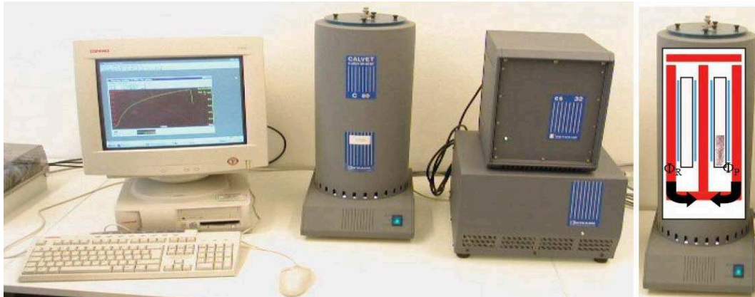
Abbildung 2.8: Messanordnung und Messprinzip des Wärmestromdifferenz-Kalorimeters (aus Clauser et al., 2007). Die Messapparatur besteht aus vier Komponenten: Rechner, Kalorimeter sowie dem Controller auf dem Netzteil (von links nach rechts).
