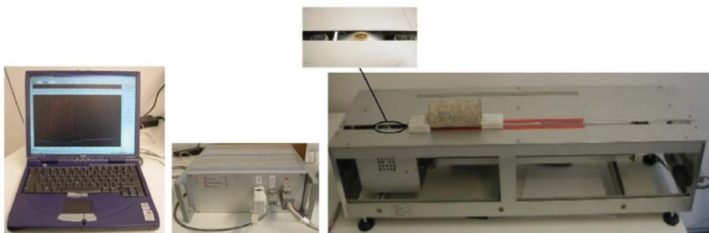
Abbildung 2.1: Messanordnung des Thermal Conductivity Scanners (aus Clauser et al., 2007). Von links nach rechts sind der Auswertungsrechner, die Steuereinheit und das eigentliche Messgerät zu sehen. Der kleine Ausschnitt lässt die beiden beweglichen Sensoren („kalt“ und „heiß“) mit der dazwischen liegenden Wärmequelle erkennen.
