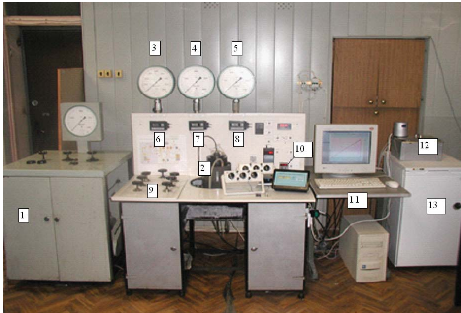
Abbildung 2.5: Apparatur zur druck- und temperaturabhängigen Messung von Wärmeleitfähigkeit, Temperaturleitfähigkeit und volumetrische Wärmekapazität. 1: Ölkompessor; 2: Druck- und Temperaturkammer; Manometer und entsprechende Steuerungen zur Kontrolle der verschiedenen Drücke: 3,6: äußerer azimuthaler Druck, 4,7: äußerer axialer Druck, 5,8,9: Ventile zur Druckeinstellung, 11: PC, 12: Thermostat und 13: Kühltank für Messungen bei niedrigen Temperaturen.
