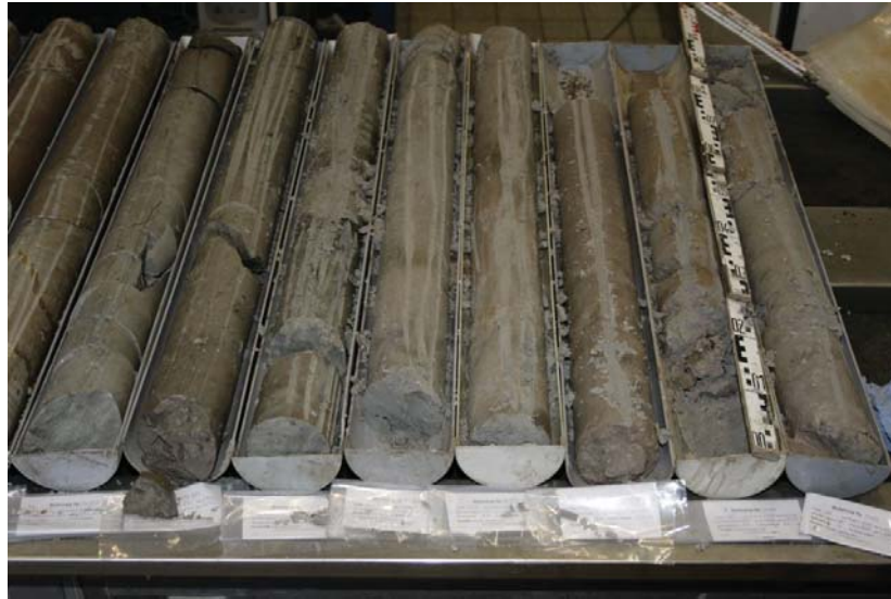
Abbildung 3.4: Sedimentkerne (hier überwiegend Sand) aus der Erkundungsbohrung HU-873 in Plastik-Linern. Im Durchschnitt wurde etwa aus jedem achten Kernmeter ein Teilstück entnommen.
