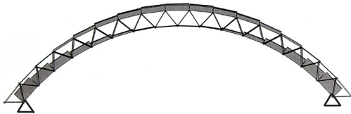
Zweilagige Segmenttonne - einfache Auflagerung Normalkräfte
