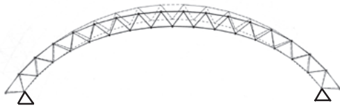
Zweilagige Segmenttonne - einfache Auflagerung Verformung
