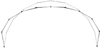
Halbkreistonne mit Parallellagerung - Verformung
