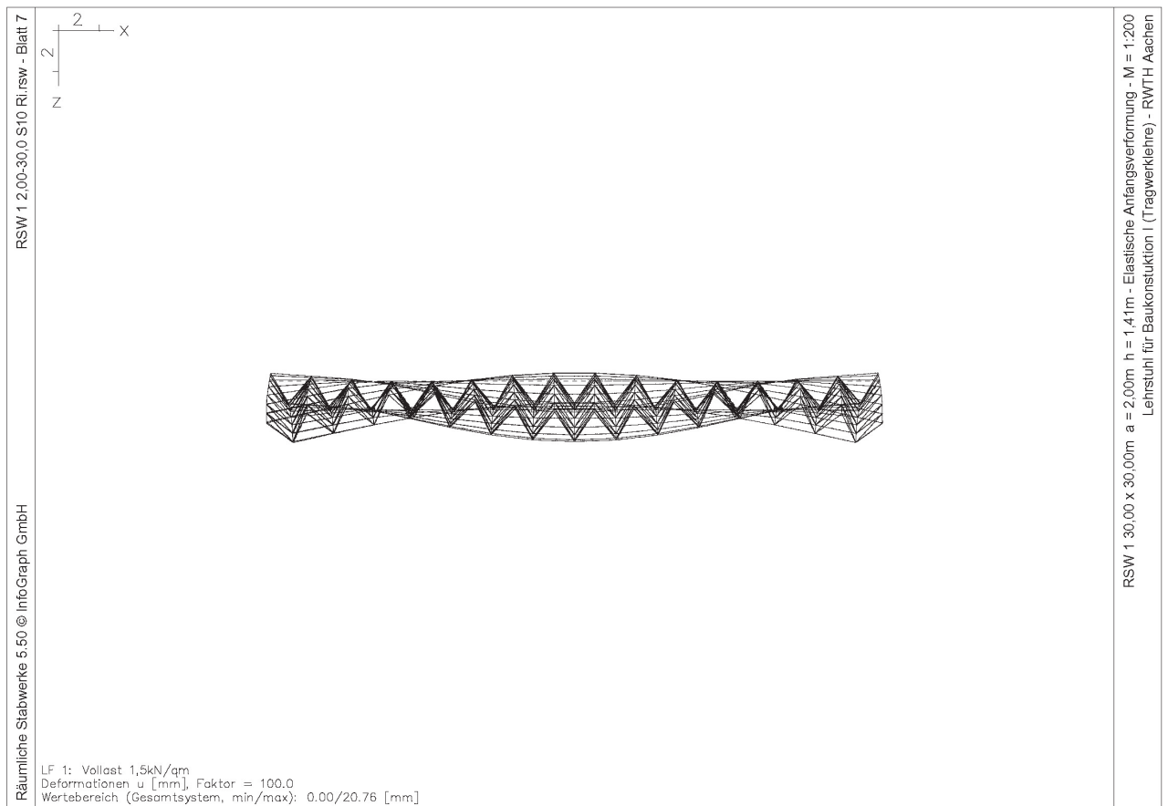
RSW 1, Umfanglagerung mit Auskragung, Elastische Anfangsverformung
