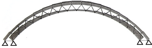
Zweilagige Segmenttonne - zweifache Auflagerung Normalkräfte
