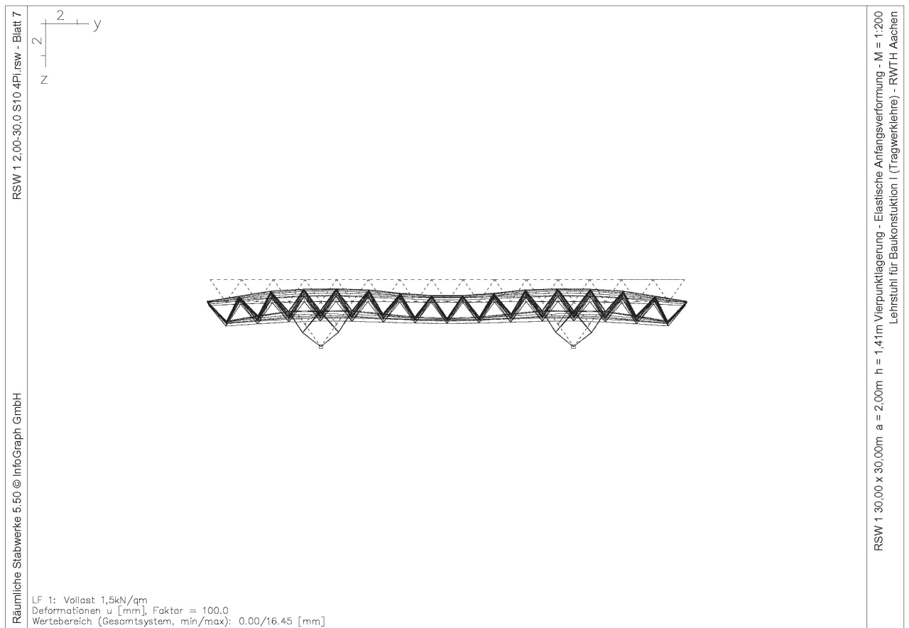
RSW 1, Vierpunktlagerung mit Auskragung, Elastische Anfangsverformung
