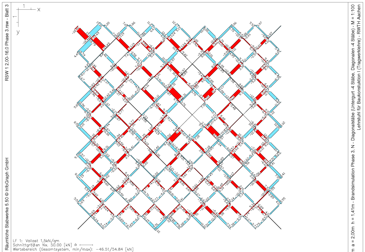
Brandsimulation, Phase 3 (Untergurt -4 Stäbe, Diagonalage -4 Stäbe), Normalkräfte Diagonalstäbe
