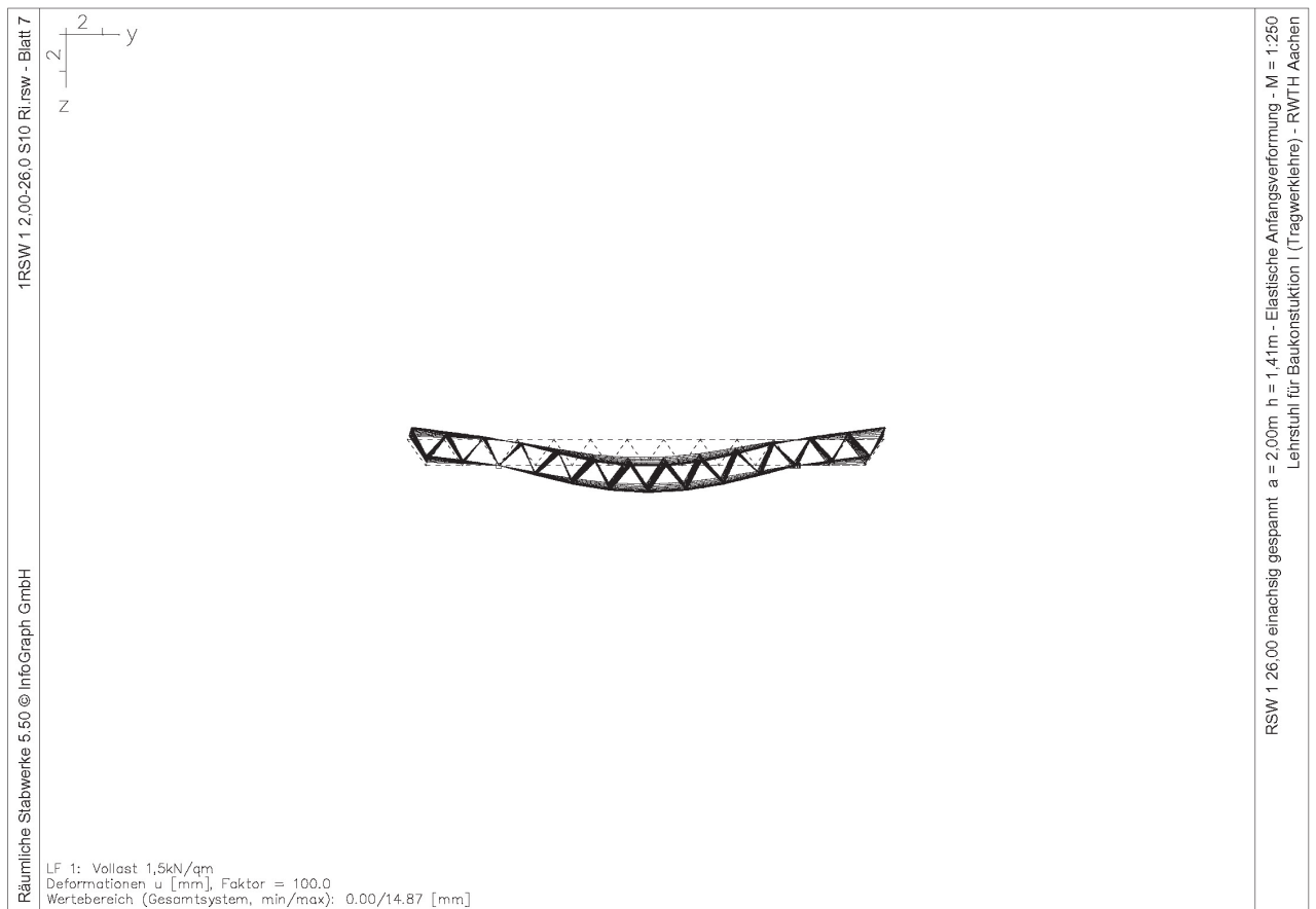
RSW 1, einachsig gespannt mit Auskragung, Elastische Anfangsverformung
