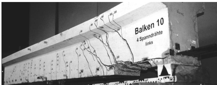
Bild 7.6: Verankerungsbruch und Absprengen der Betondeckung
