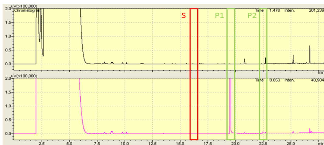
Abbildung 3.52: Gaschromatogramm zur Bestimmung der Reinheit des aufgereinigten Pimelinsäuremonopentylesters (unten) im Vergleich zu einer Injektion von Chloroform mit Derivatisierungsreagenz (oben). Substrat (S): Pimelinsäure (rot-umrandet); Produkte (P): Pimelinsäuremono- (P1) und Pimelinsäuredipentylester (P2) (jeweils grün-umrandet).
