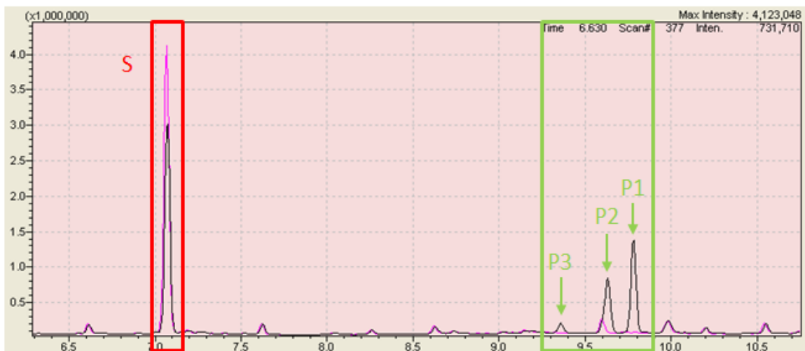
Abbildung 3.38: GC-MS-Analyse (in Düsseldorf) des in (a) gezeigten Umsatzes von Tridecansäure durch CYP102K1. (b): Im Gaschromatogramm sind in der Probe (schwarz) im Vergleich zur Negativkontrolle ohne CYP102K1 (pink) drei Produktpeaks erkennbar (S: Substrat (rot-umrandet), P: Produkt (grün-umrandet)). Reaktionsbedingungen der Biokatalyse: 2 \mu\text{M} CYP102K1, 0,2 mM Tridecansäure, 0,1 mM \text{NADP}^+ , 20 mM Glucose, 10 U/mL GDH IV (1 U entsprach der Enzymmenge, welche 1 \mu\text{mol} \text{NADP}^+ pro Minute bei pH 7,5 und RT reduzierte), 1.200 U/mL Katalase, 100 mM \text{KP}_i -Puffer (pH 7,5), 25 °C, 17 h, ohne Durchmischung.
