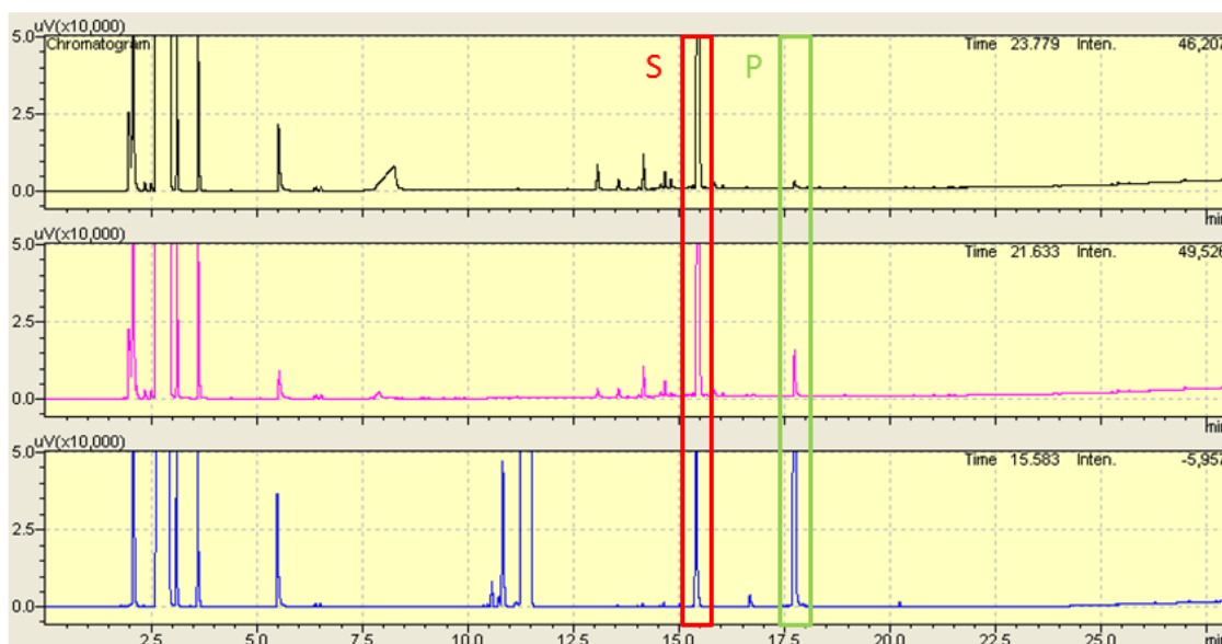
Abbildung 3.37: Gaschromatographische Analyse des Umsatzes vom Substrat \beta -Jonon (S) durch CYP102K1 (pink) im Vergleich zur Negativkontrolle ohne CYP102K1 (schwarz) und zum \beta -Jonon-Umsatz durch CYP154H1 (blau). Der Substratpeak ist rot-umrandet, der Produktpeak (P) ist grün-umrandet. Verwendete GC-Methode: Methode 1 (siehe Abschnitt 2.5.2).
