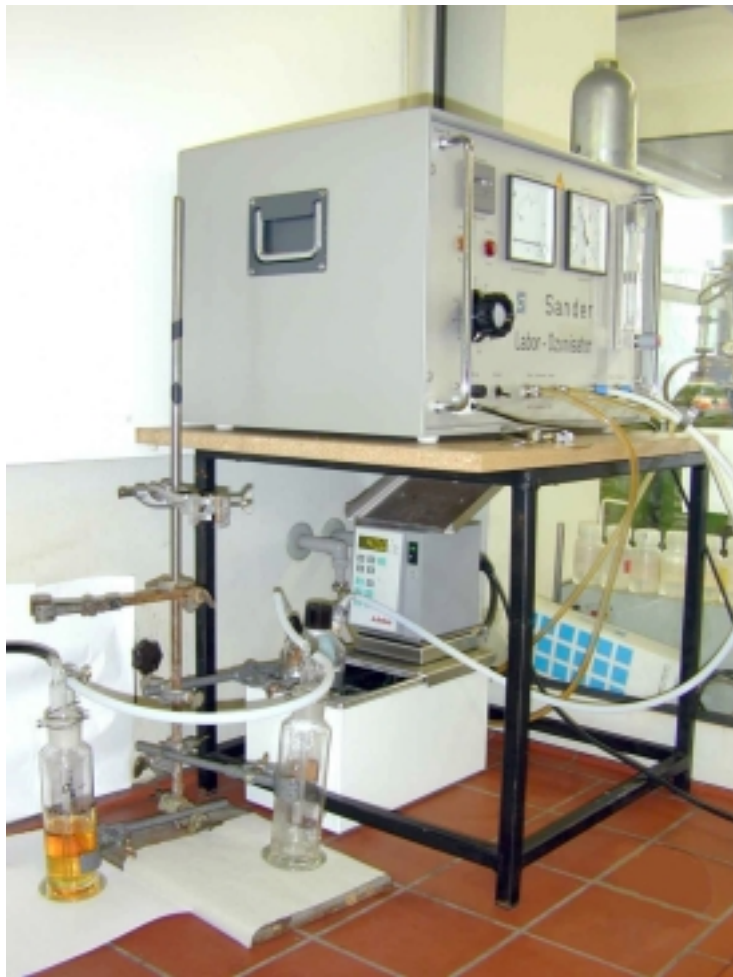
Abb. 68. Laborozonisator mit temperierter Begasungskammer, Sicherheitswaschflasche und Kaliumiodid-Lösung zur Vernichtung überschüssigen Ozons.
