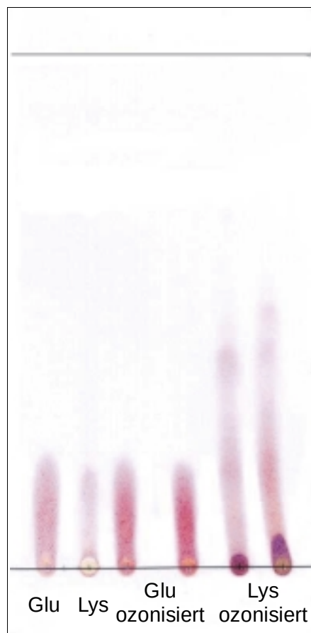
Abb. 33. Dünnschichtchromatographische Trennung der ozonisierten Aminosäuren Glutaminsäure und Lysin im Vergleich zu den Ausgangssubstanzen (die ozonisierten Aminosäuren sind doppelt aufgetragen).
