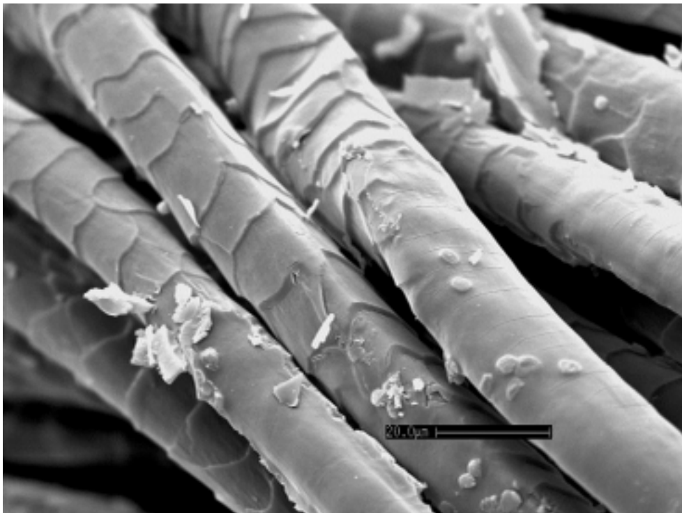
Abb. 57. REM-Aufnahme einer Faser aus den Schussfäden eines 3 h lang ozonierten Wollgewebes in 1000-facher Vergrößerung.
