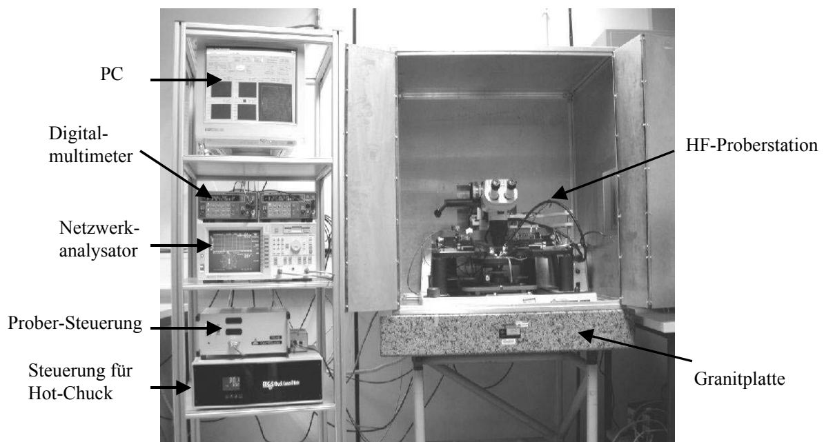
Abbildung 5.3: HF-Probermessplatz PSM6 des Herstellers Karl Süss (im abgeschirmten Gehäuse)
