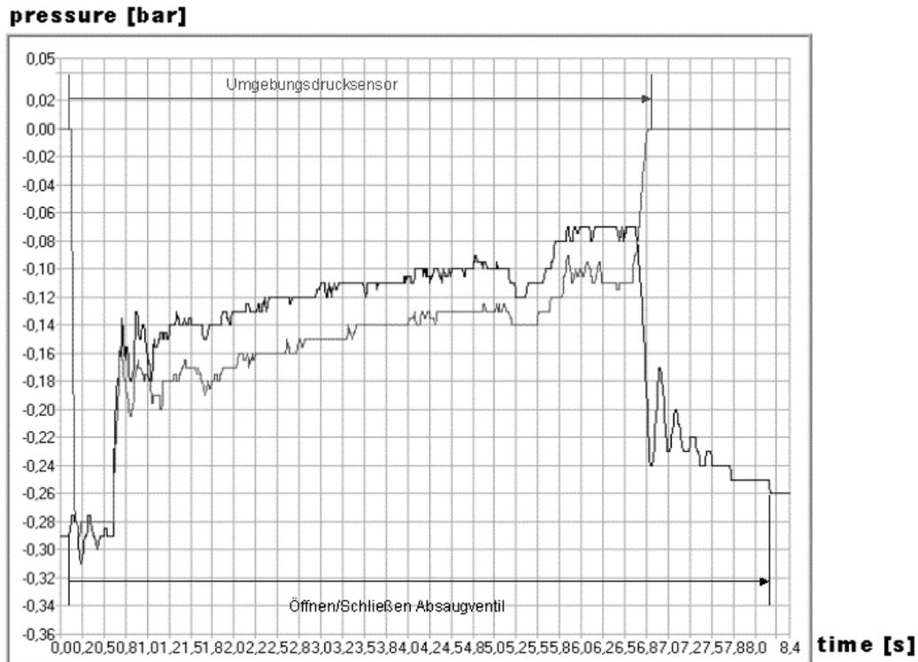
**Abb. 5-4: Druckbild bei 2500 ml Gel + 3000 ml Wasserfüllung**
