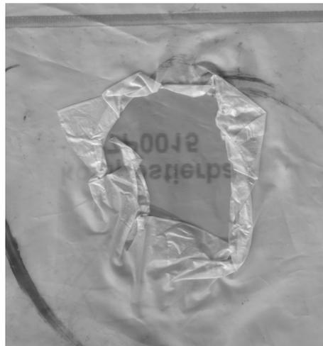
**Abb. 5-5: Sichttest nach Entleerung des Waste Tank - Loch im Beutel**
