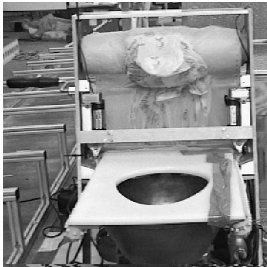
**Abb. 4-14: Prototyp wasserlose Toilette**
