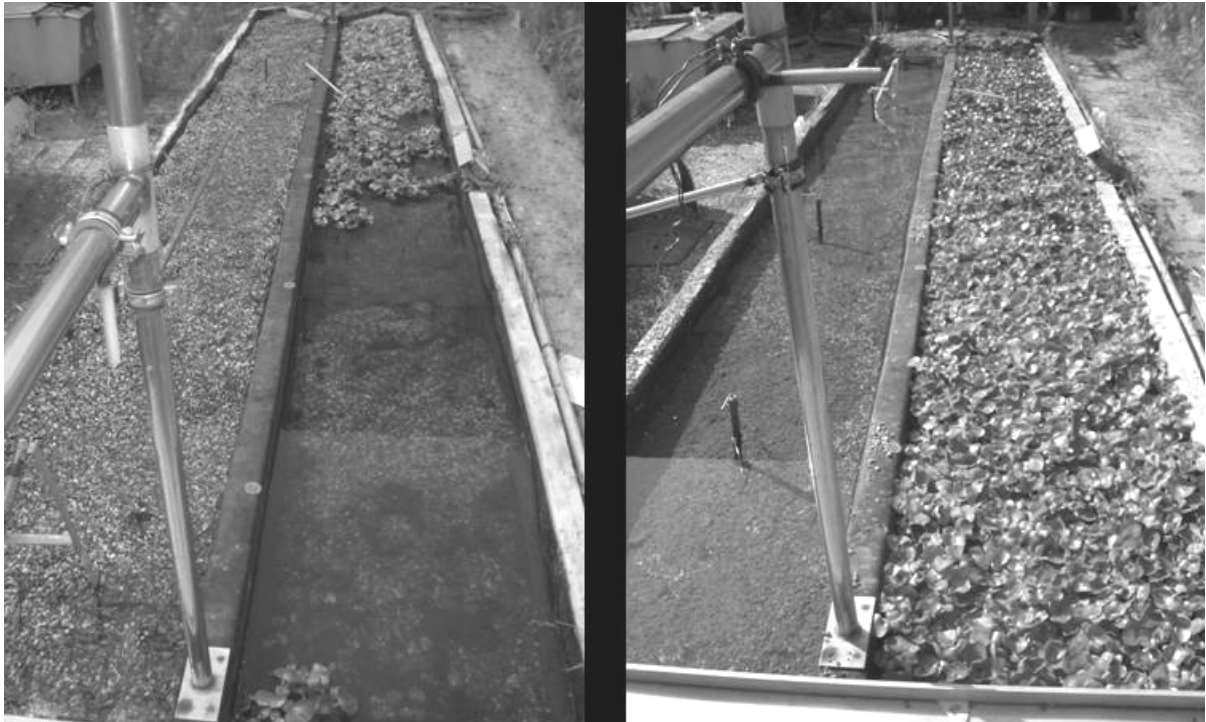
Abbildung 2.7: AMOVA 2005; links: 16.06.2005, 20 Tage nach Ausbringung; rechts: 14.07.2005, 48 Tage nach Ausbringung der Wasserhyazinthen (Blickrichtung vom Ablauf); Die jeweils linke Bahn ist die unbewachsene Kies-Kontrolle. Zum Ende der Vegetationsperiode 2005 wurden gegen Anfang Oktober die Versuche eingestellt. Zu diesem Zeitpunkt waren die nächtlichen Temperaturen schon deutlich zu gering für die tropischen Pflanzen, sodass diese bereits teilweise chlorotisch wurden.
