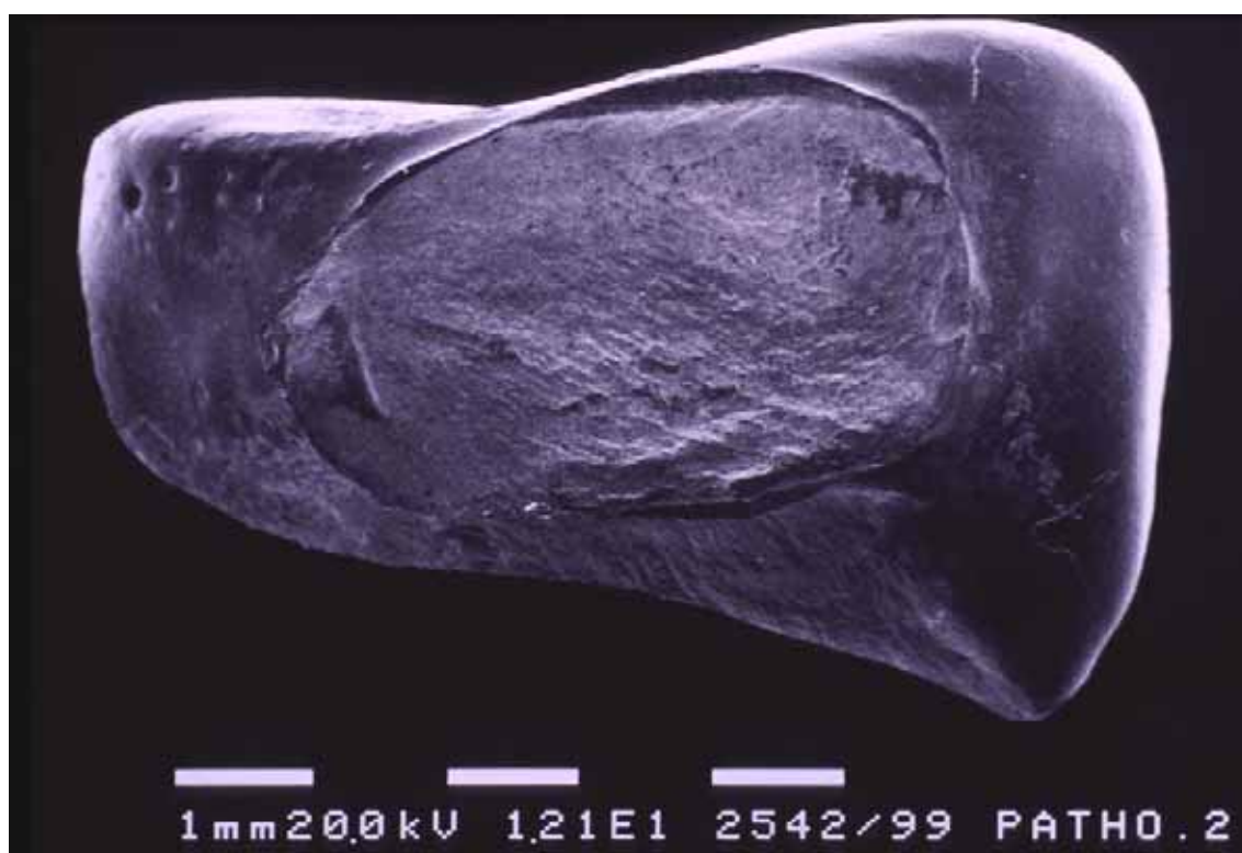
Abb. 4-21: Verbinderfraktur im REM-Bild (Foto: Prof. Dr. D. Edelhoff)
