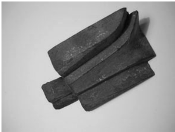
Bild 0.19: Links ein Kern aus C-AeroSand (Alodur®). Auf dem rechten Bild ist der Kern durch einen Verbrennungsprozess herausgelöst worden. Es ist eine gute Abbildungsgenauigkeit zu erkennen.
