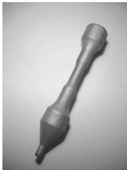
Bild 4.47: Verschiedene Gussteile abgegossen in Kohlenstoff AeroSand Formen aus unterschiedlichen Sanden. Vergossen wird die Legierung A357.
