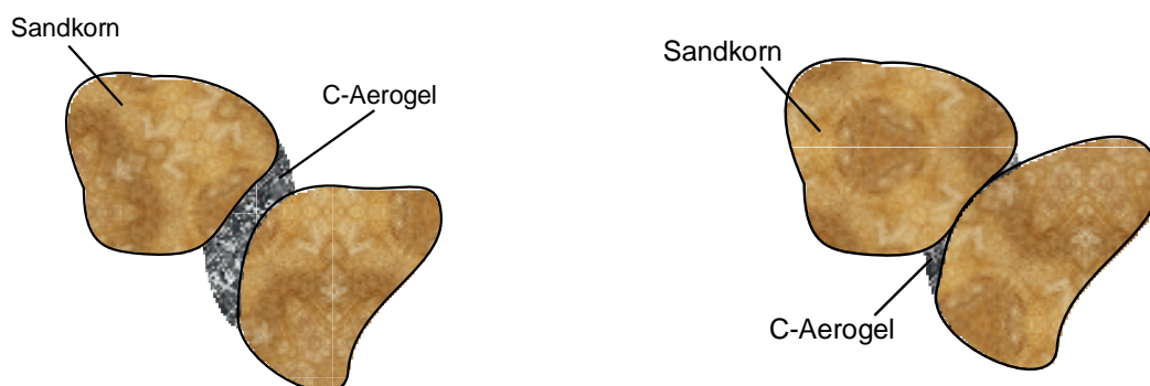
Bild 4.20: Die Festigkeiten der SiC C-AeroSande nehmen auf Grund des Sintervorgangs der SiC Körner mit sinkendem Binderanteil ab. Dargestellt ist links ein 24%iger AeroSand, bei dem die Wahrscheinlichkeit eines direkten Sandkornkontaktes geringer ist, als bei in einem AeroSand mit 10% Binderanteil (rechts).
