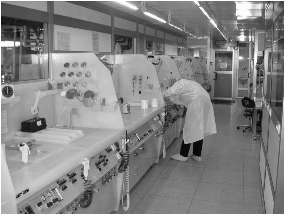
Abbildung 3.8: Nassbänke für Lift-Off, Spincoating und Ätzprozess
