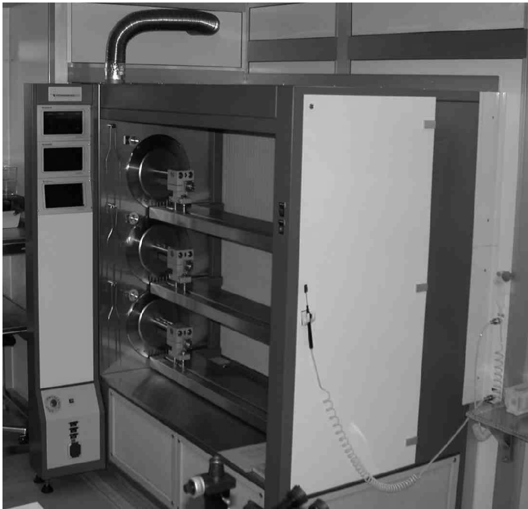
Abbildung 3.2: Oxidationsofen zur nasschemischen Oxidation von Silizium
