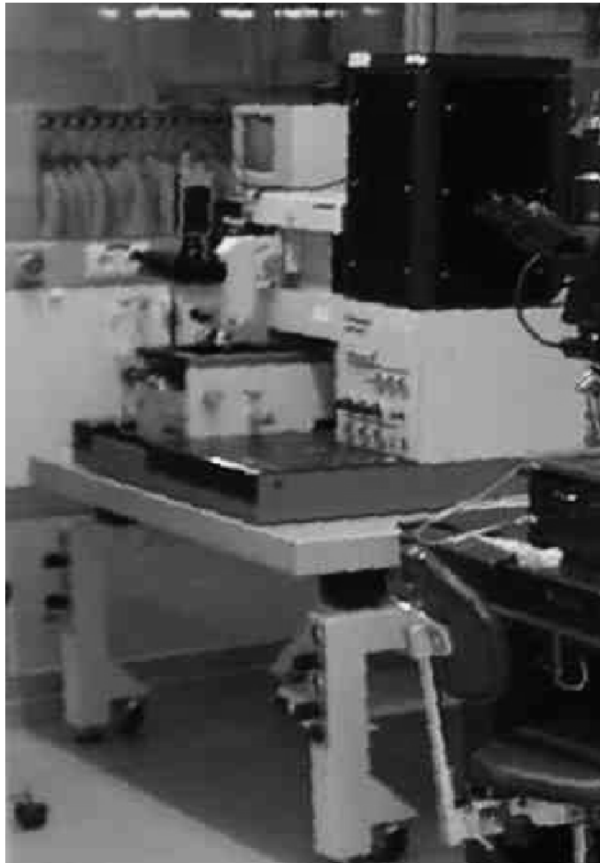
Abbildung 3.5: Belichter für die Photostrukturierung
